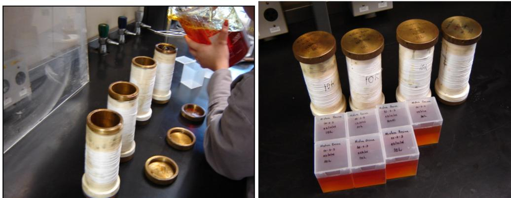
Figura 3.3 - Moldagem e preparação dos CP's para a hibernação de 21 dias
