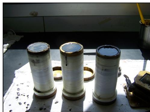
Figura 3.6 – Na confecção da MISTURA de resina epóxi e cimento para os corpos-de-prova da série C utilizou-se uma batedeira a baixa rotação. Os corpos cilíndricos mesmo durante a moldagem apresentaram liberação de bolhas muito pequenas e uma textura mais compacta.
