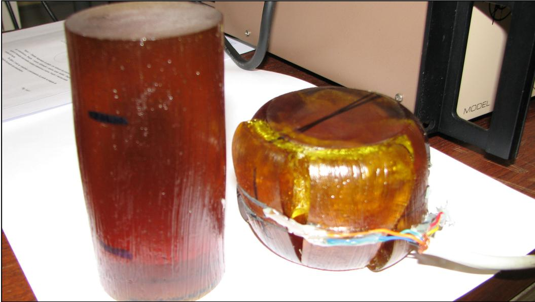
Figura 3.15 - Comparação entre um corpo-de-prova rompido após o ensaio de compressão e o outro que ainda seria ensaiado (corpos preparados à temperatura de 70°C).
