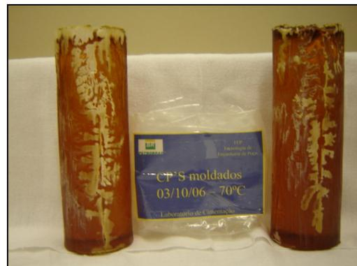
Figura 3.5 - Corpos-de-prova após a retirada dos moldes cilíndricos. Os corpos cilíndricos apresentando ranhuras e marcar de passagem de bolhas.
