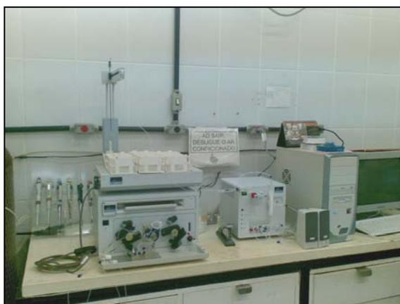
Figura 16. Espectrômetro de absorção atômica com vapor frio, modelo FIMS 400 (Perkin Elmer), associado a um sistema de injeção em fluxo, modelo FIAS 400 (Perkin Elmer) e equipado com um sistema automático de amostragem líquida, modelo AS 90 (Perkin Elmer).
