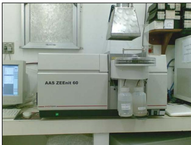
Figura 15. Espectrômetro de absorção atômica com forno de grafite Analytik Jena, modelo AAS ZEE nit 60 e sistema automático de amostragem líquida Analytik Jena (modelo MPE 52) acoplado.
