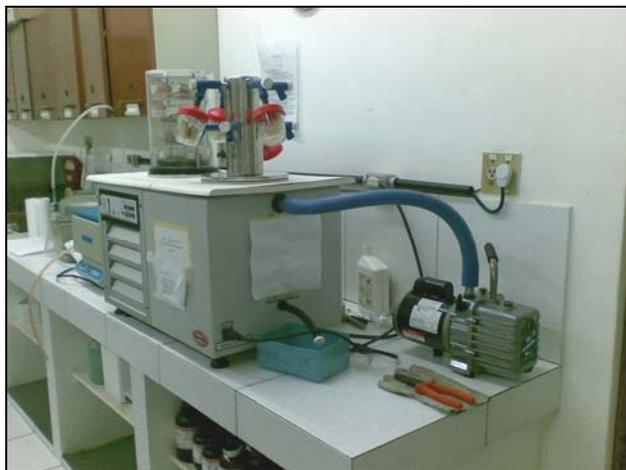
Figura 14. Liofilizador Terroni (série LD) acoplado a uma bomba de vácuo.
