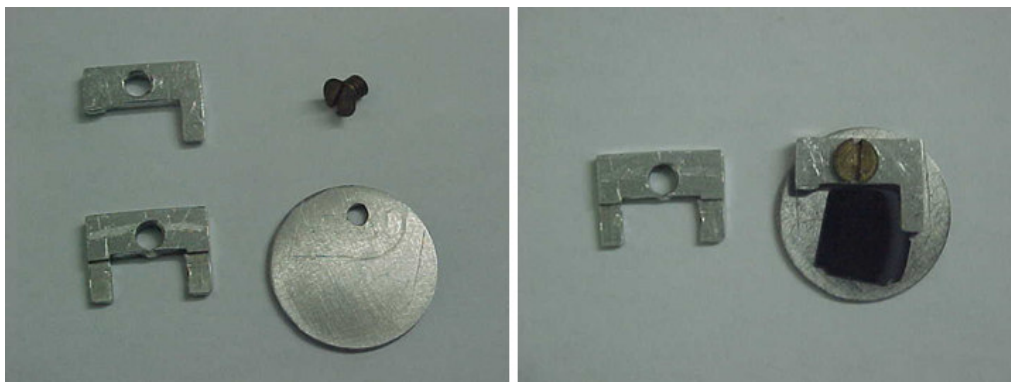
Figura 28 - Foto das peças do porta-amostra desmontado a esquerda, e montado com um substrato de InP a direita.
