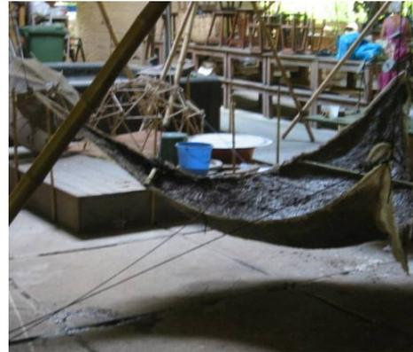
Figura 201. Casca já com forma estabilizada.
