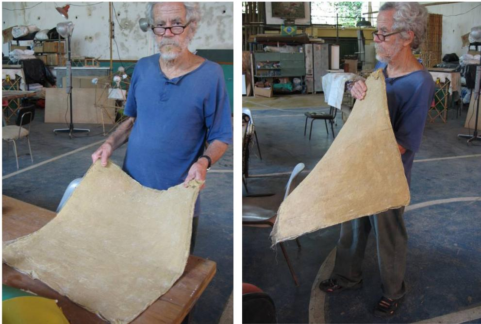
Figuras.292 e 293. Demonstração de moldabilidade da folha maleável de fibrosolo
