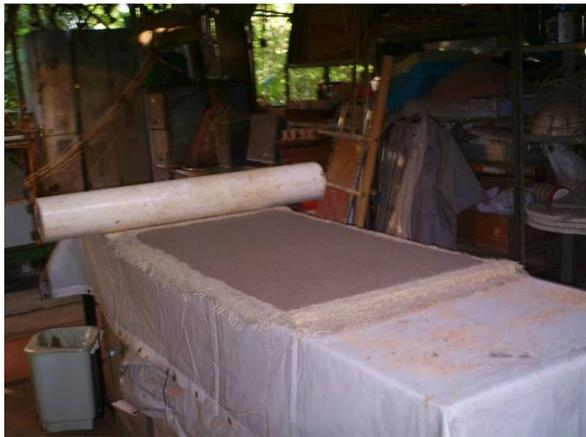
Figura 290. Prensagem de folha de fibrosolo
