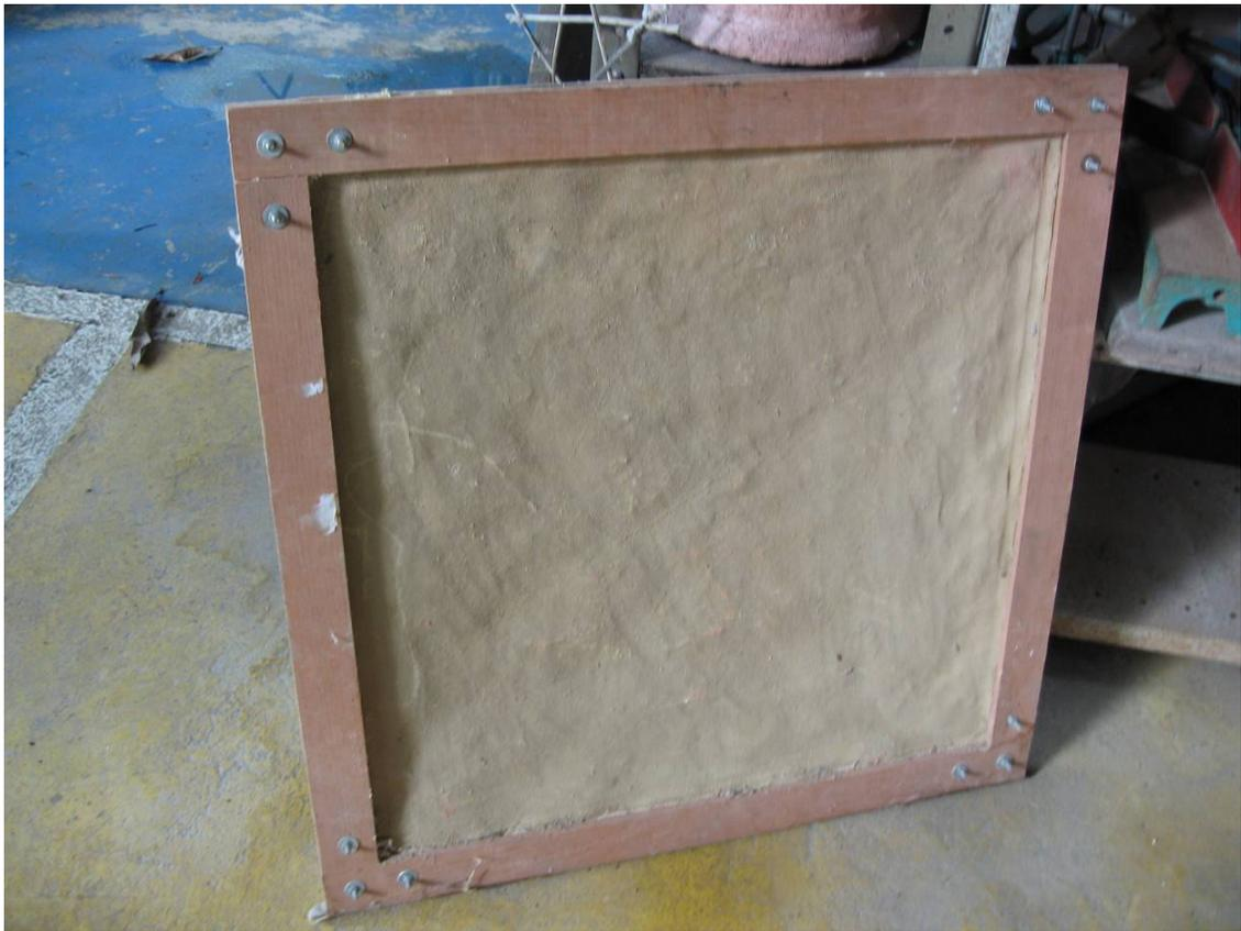
Figuras 270, 271 e 272. As ilustrações mostram um sistema modular construtivo de encaixes baseado em painéis formados por quadros com sobras de madeira. A placa de fibrosolo mostrou-se perfeitamente ajustável e adequada ao sistema.
