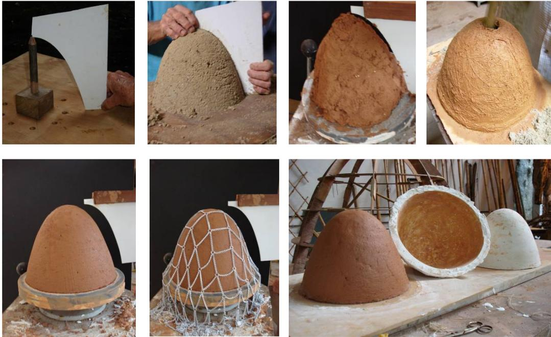
Figuras 234, 235, 236, 237, 238, 239 e 240. Dispositivos experimentais simuladores da forma ogival projetada para a cúpula. Condução a partir de gabarito com curva catenária.
