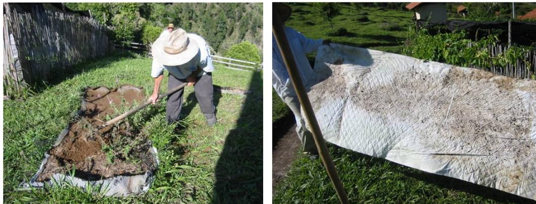
Figuras 189 e 190. Desmonte da estrutura e retirada das camadas do experimento, mostrando a integridade da manta de respiração Tyvek.
