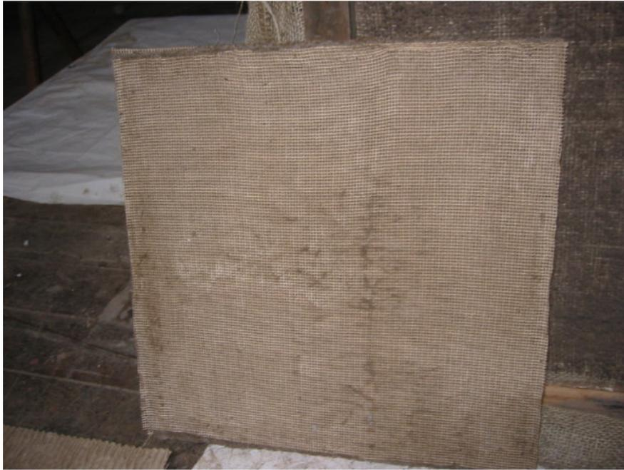
Figura 266, placa revestida com manta de entretela de algodão
