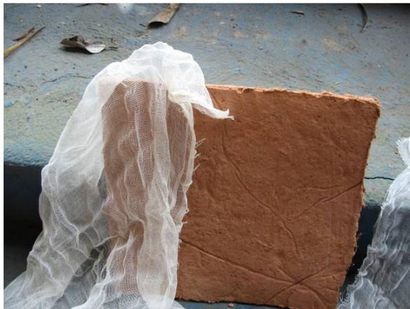
Figura 260. Placa de fibroso com gaze industrial
