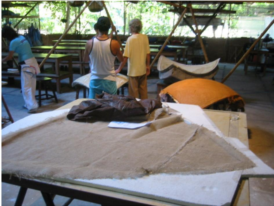
Figura 224, Modelagem de mantas de juta para confecção de cascas triangulares de dupla curvatura.
