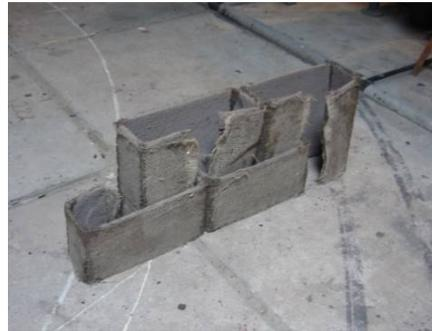
Figuras 267, 268, e 269. Sistema modular para construção baseado no princípio de placas de fibrosolo dobradas
