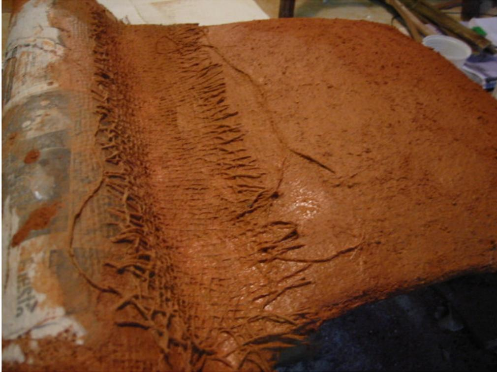
Figura 221,. Face inferior do experimento com peça de dupla curvatura e emenda na calha laminada.
