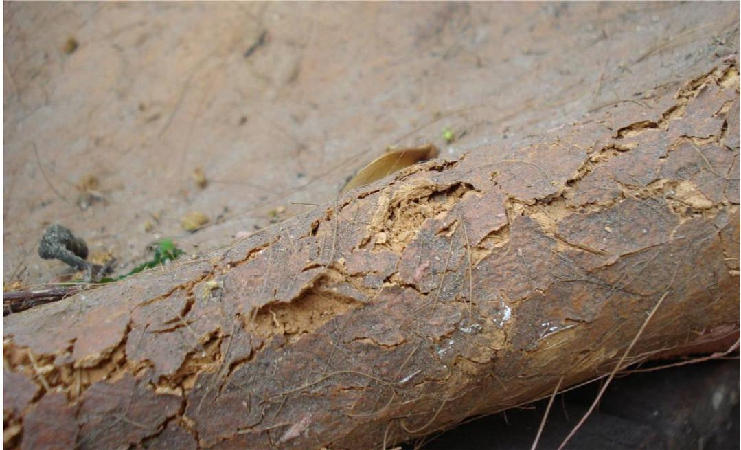
Figura 231. Detalhe de dobra da casca de fibrosolo onde se nota a película protetora de Barro com PVA mantendo ainda parte da proteção do material.
