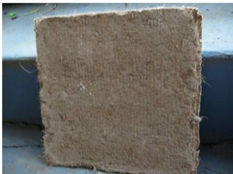
Figura 273. Amostra de placa sem revestimento, apenas confeccionada com o compósito de fibras e terra.
