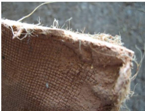
Figura 261. Detalhe de placa com gaze industrial
