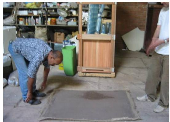
Figuras 286, 287, 288 e 289. Movimento de transporte da folha de fibrosolo, mostrando mancha da deformação originada pelo ensaio anterior.
