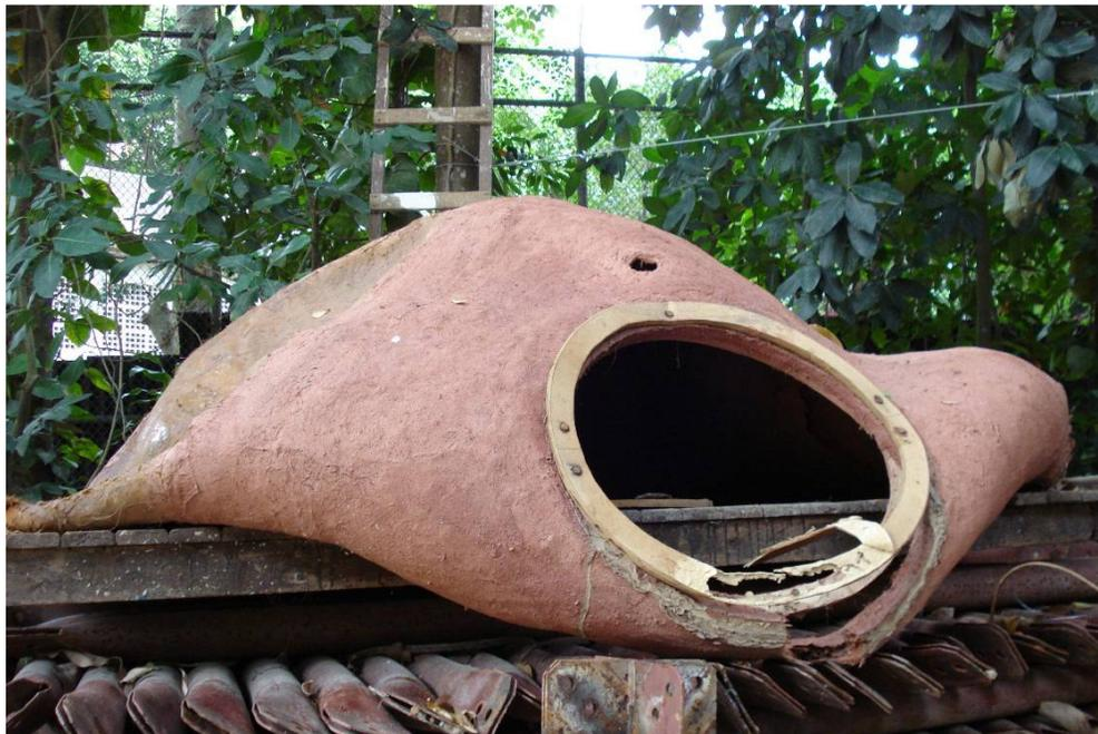
Figura 230. Cúpula semi-esférica deformada pela absorção de umidade. A superfície se acomoda formando curvaturas sem se romper. Apresenta também a ação de cupins que se limitou a agir na moldura de aglomerado mdf, sem interferir no fibroso.
