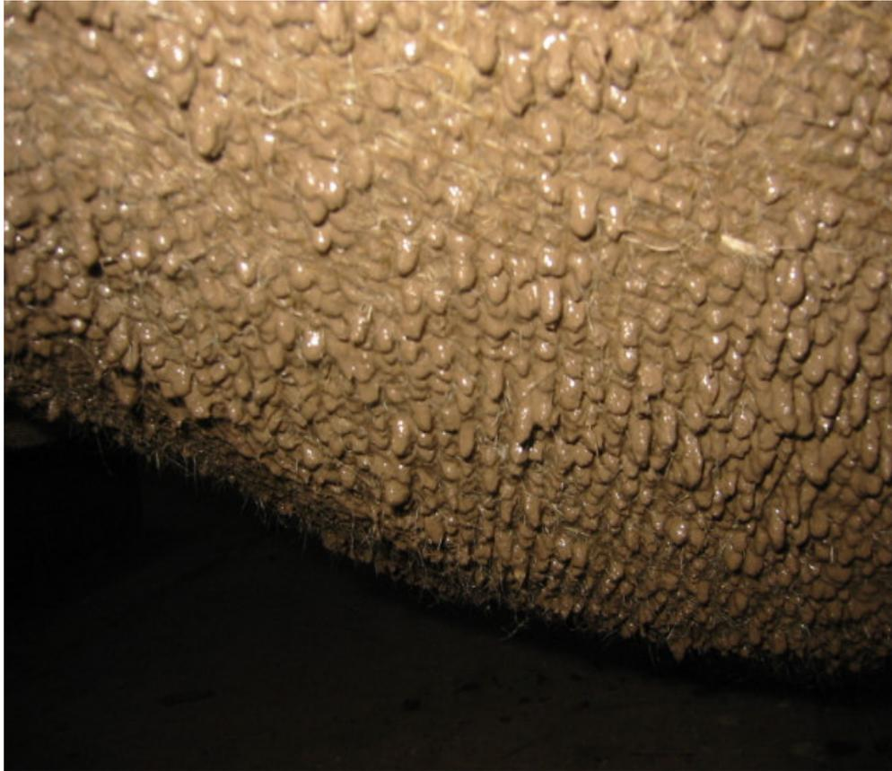
Figura 195. Superfície de casca de curvatura invertida tensionada pelo peso próprio do fibrosolo com textura provocada pelo transpasse de trama de juta
