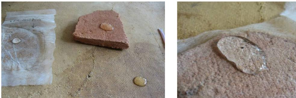
Figuras 181 e 182. Amostras de fibroso com aplicação de lanolina e detalhe de gota de água sobre superfície protegida.
