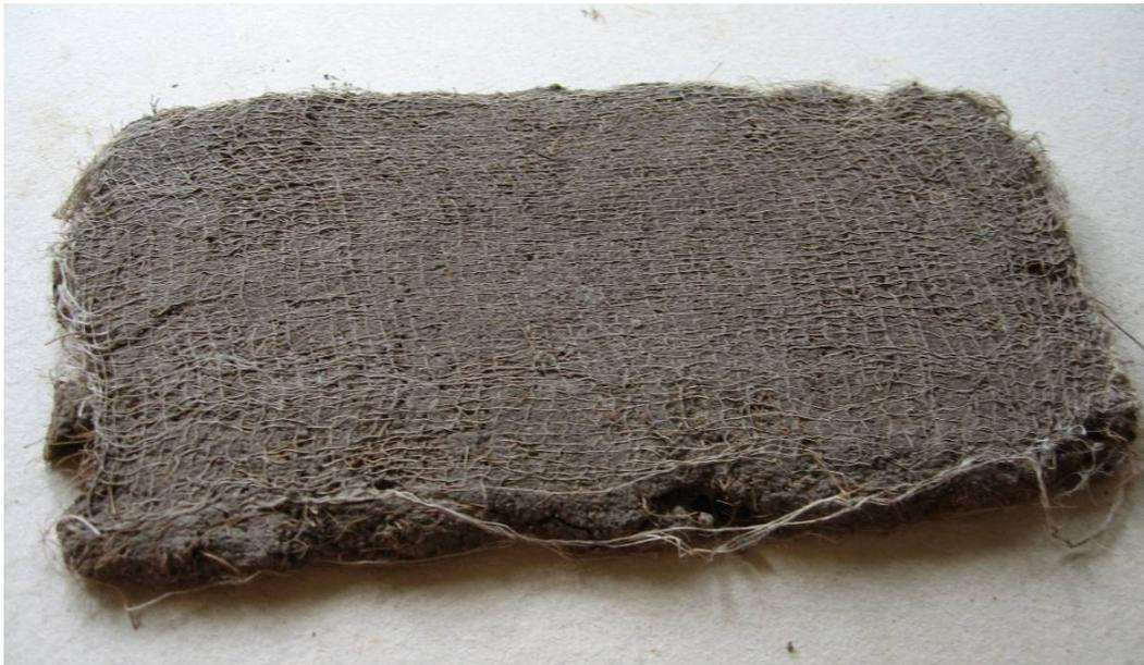
Figura 263. Amostra de placa com gaze industrial mostrando camada da trama com barro
