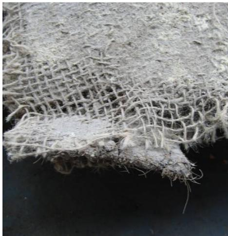
Figura 264, placa revestida com manta de juta onde a característica de descolamento fica evidenciada
