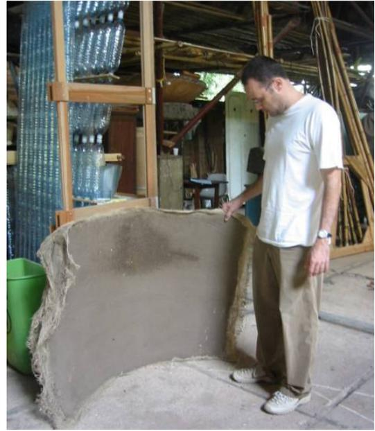
Figuras 284 e 285. Folha de fibrosolo apoiada em posição autoportante . A imagem mostra também a folha de fibrosolo com as duas mantas superficiais de juta xxx
