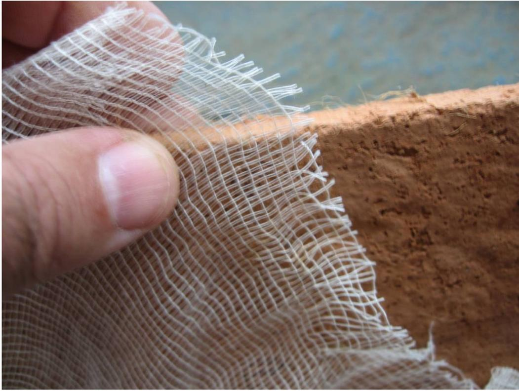
Figura 262. Detalhe de placa com gaze industrial onde a integração dos materiais se torna de tal ordem que as fibras ficam despercebidas.
