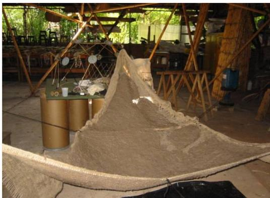
Figura 199. Manta de juta recebendo compósito de fibrosolo
