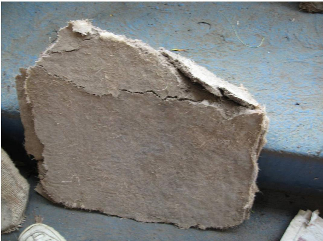
Figura 259. Placa de fibrosolo revestida com papel de bananeira rompido. As camadas seqüenciais do laminado se mostram presentes.
