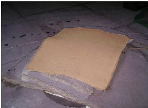
Figura 291. Folha de fibrosolo em deformação
