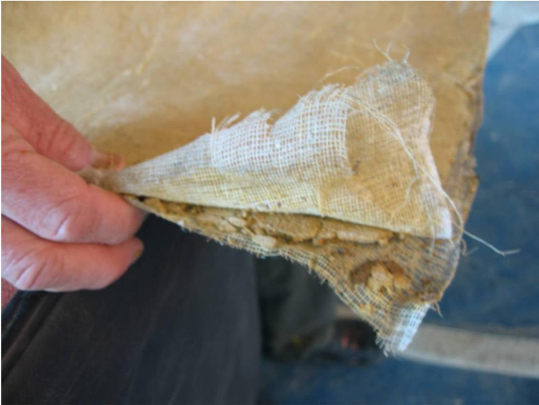
Figura 297. Detalhe das camadas laminadoras da folha de fibrosolo
