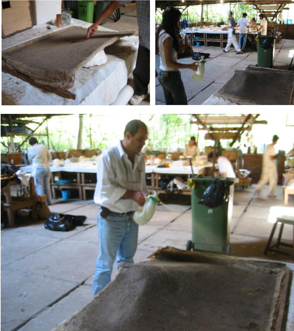
Figuras 281, 282 e 283. Ensaio de indução à deformação da folha de fibroso. Fica nítida a curvatura porém sobressaem-se algumas dobras
