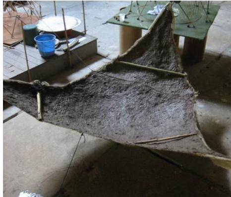
Figura 200. Superfície do triângulo em estabilização com peso próprio do compósito.
