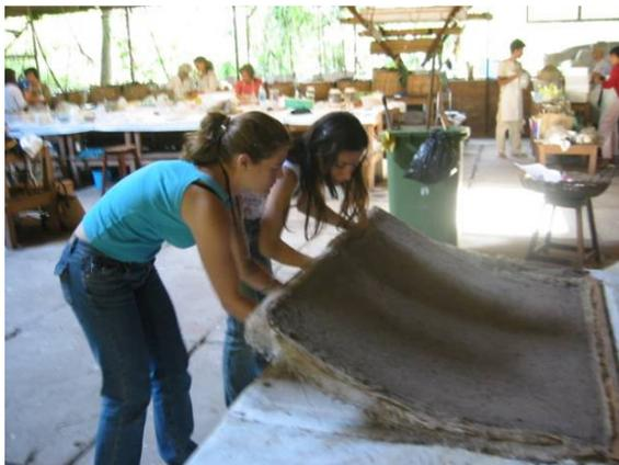
Figuras 280. Folha de fibrosolo sendo apoiada sobre  $\frac{1}{2}$  esfera
