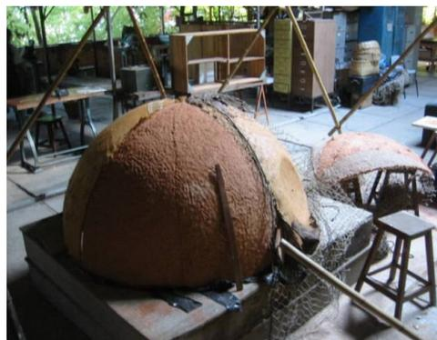
Figura 228. Cúpula de fibrosolo sobre base
