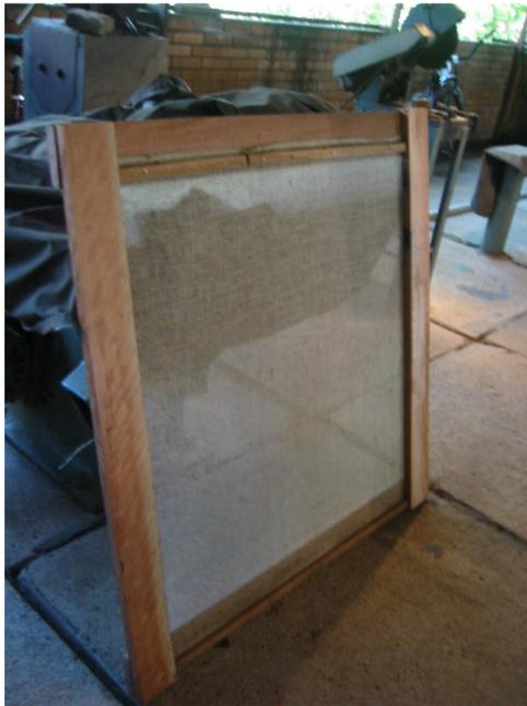
Figura 274. Tela tensionada preparada para receber o compósito.
