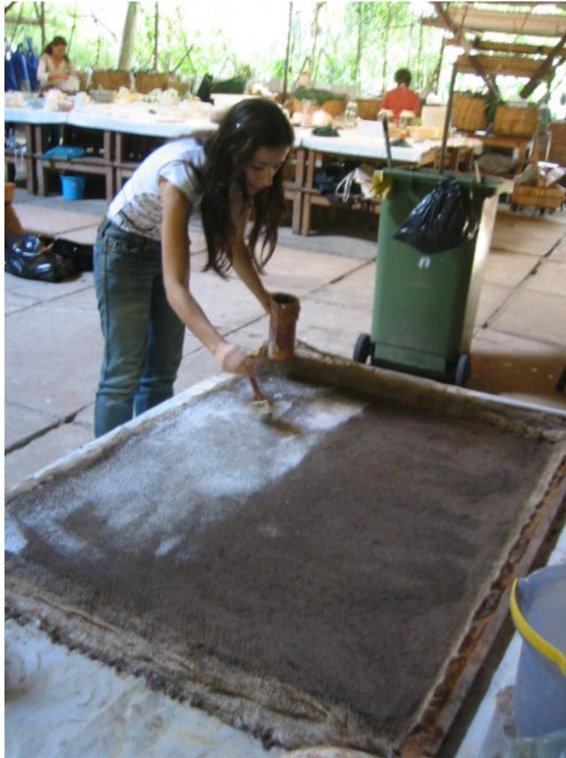
Figura 173. Aplicação de PVA diluído em água para proteção de placa de fibrosolo.
