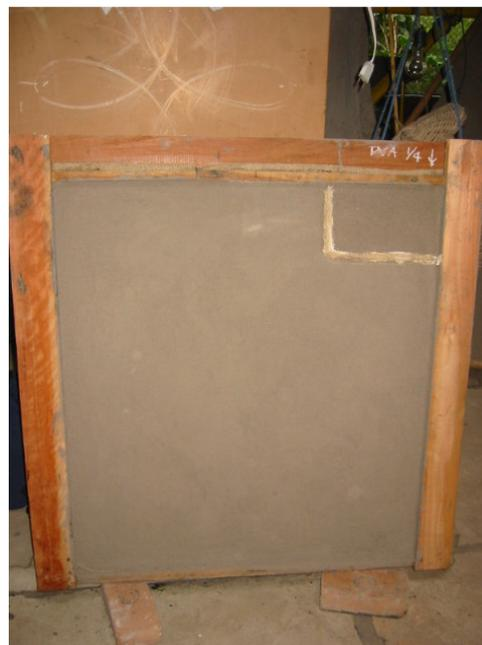
Figura 275. Folha de fibrosolo com detalhe de aplicação de PVA diluído em água (1:4).
