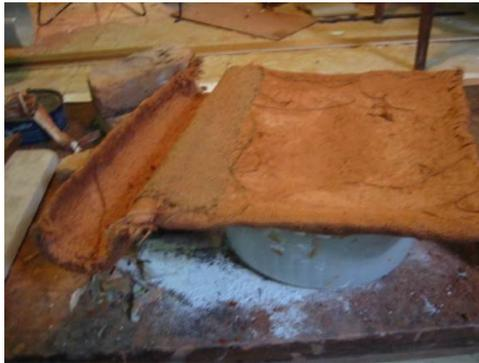
Figura 218. Peça piloto de sistema calha/telha
