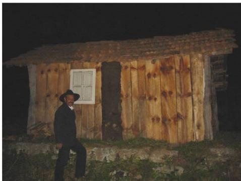
Figura 133. Abrigo no bairro do Monteiro, Itamonte-MG que utiliza técnica tradicional local com tabuas de costaneira de pinheiro nativo.
