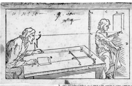
Figura 15. Pespectografo. Cigoli, *Prospettiva pratica*, ms., ca. 1613. Gabinetto dei Disegni e delle Stampe degli Uffizi, Florence. Retirado de CAMEROTA, Filippo. Looking for an artificial eye: on the borderline between painting and topography. *Early Science and Medicine* 10 (2).
