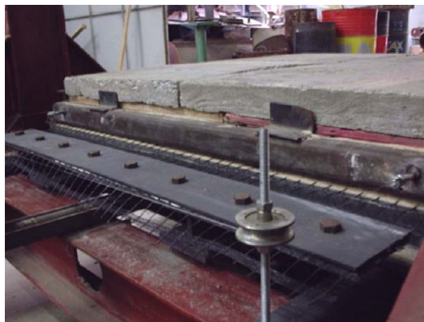
Figura 20 - Sistema de fixação do geossintético (Rezende,2005)
