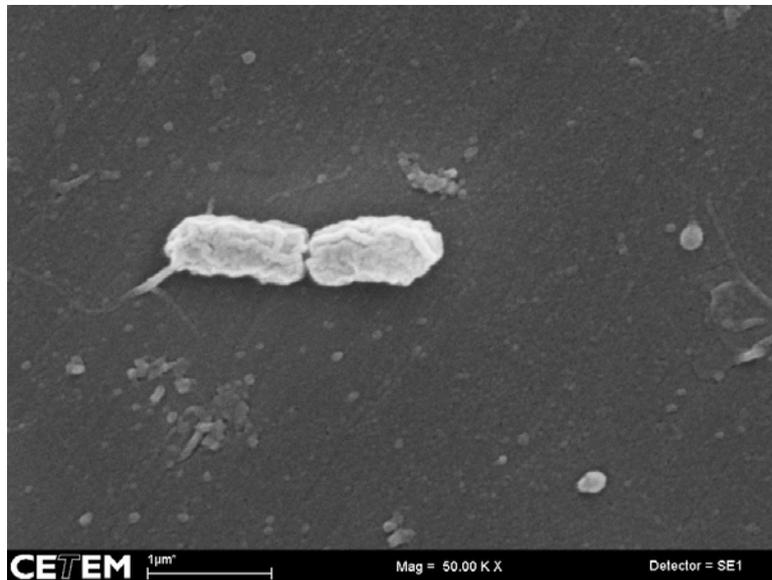
Figura 28 – análise por MEV de biofilme em cupom de S32750 após 15 dias de ensaio. Aumento 50000X. Polimento superficial de 6μm.
