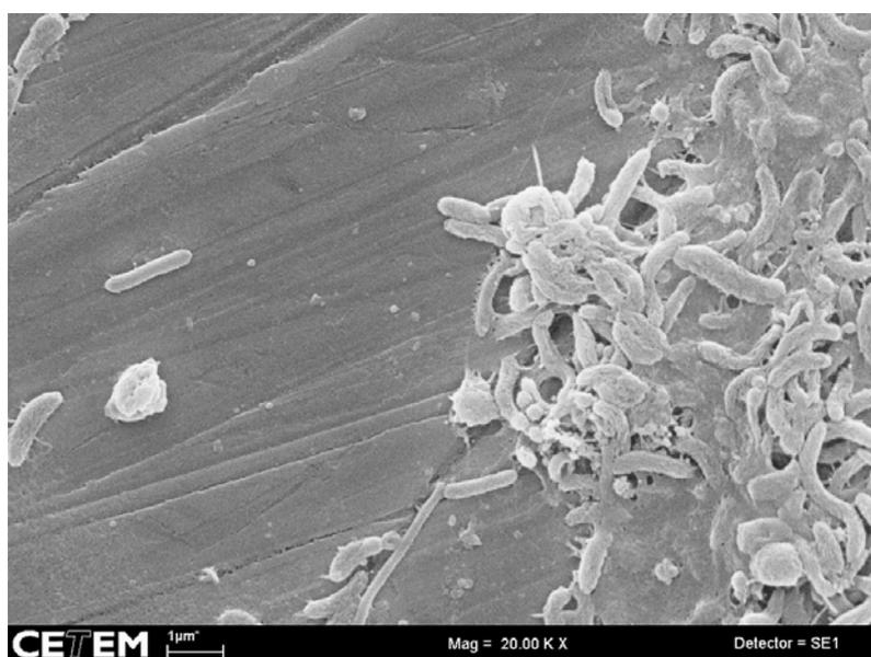
Figura 38 – análise por MEV de biofilme em cupom de S32750 após 15 dias de ensaio. Aumento 20000X. Polimento superficial de 1μm.
