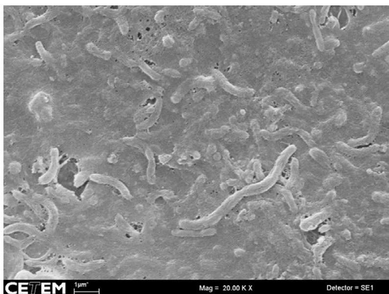
Figura 36 – análise por MEV de biofilme em cupom de S32750 após 15 dias de ensaio. Aumento 20000X. Polimento superficial de 1µm.
