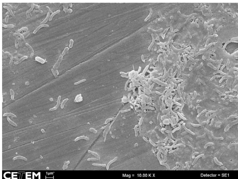
Figura 37 – análise por MEV de biofilme em cupom de S32750 após 15 dias de ensaio. Aumento 10000X. Polimento superficial de 1μm.
