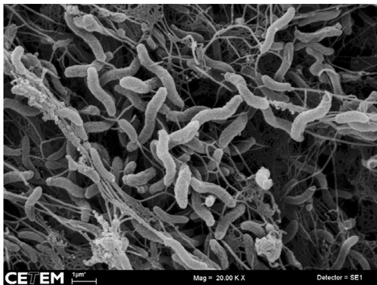
Figura 52 – análise por MEV de biofilme em cupom de 316 após 15 dias de ensaio. Aumento 20000X.
