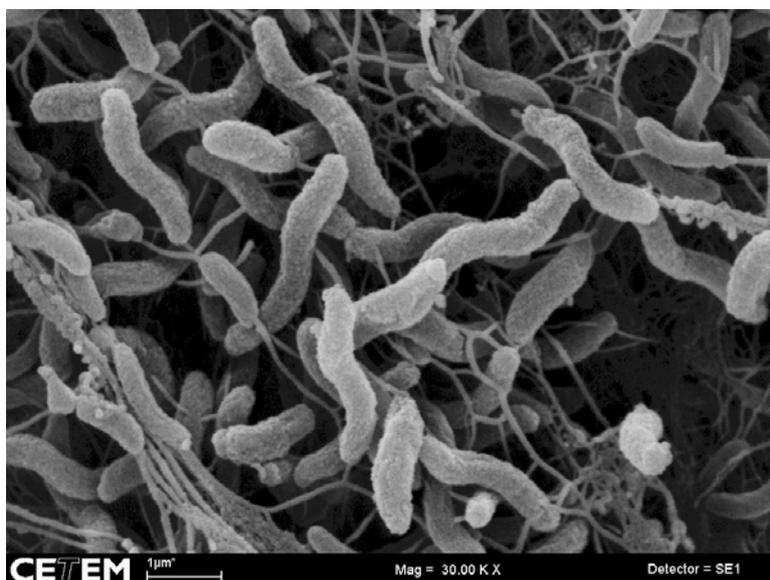
Figura 53 – análise por MEV de biofilme em cupom de 316 após 15 dias de ensaio. Aumento 30000X.
