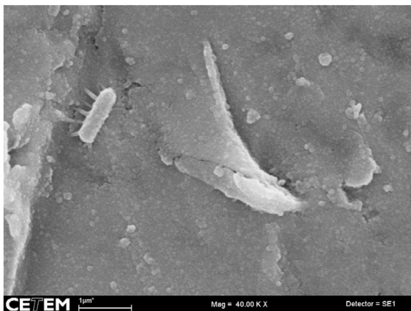
Figura 61 – análise por MEV de biofilme em cupom de AISI 316 após 35 dias de ensaio. Aumento 40000X.
