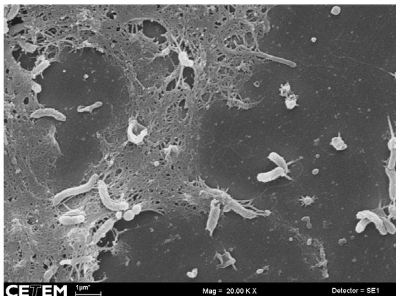
Figura 27 – análise por MEV de biofilme em cupom de S32750 após 15 dias de ensaio. Aumento 20000X. Polimento superficial de 6µm.
