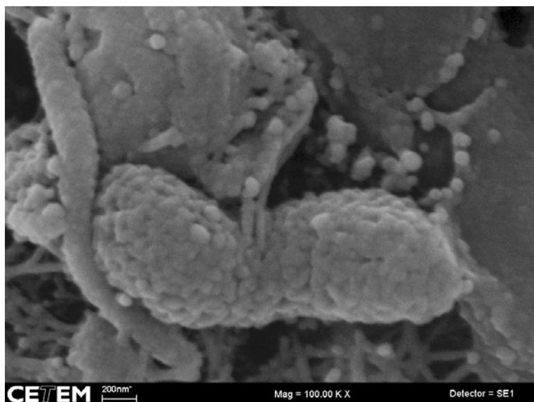
Figura 22 – análise por MEV de biofilme em cupom de S32750 após 15 dias de ensaio. Aumento de 100000X.
