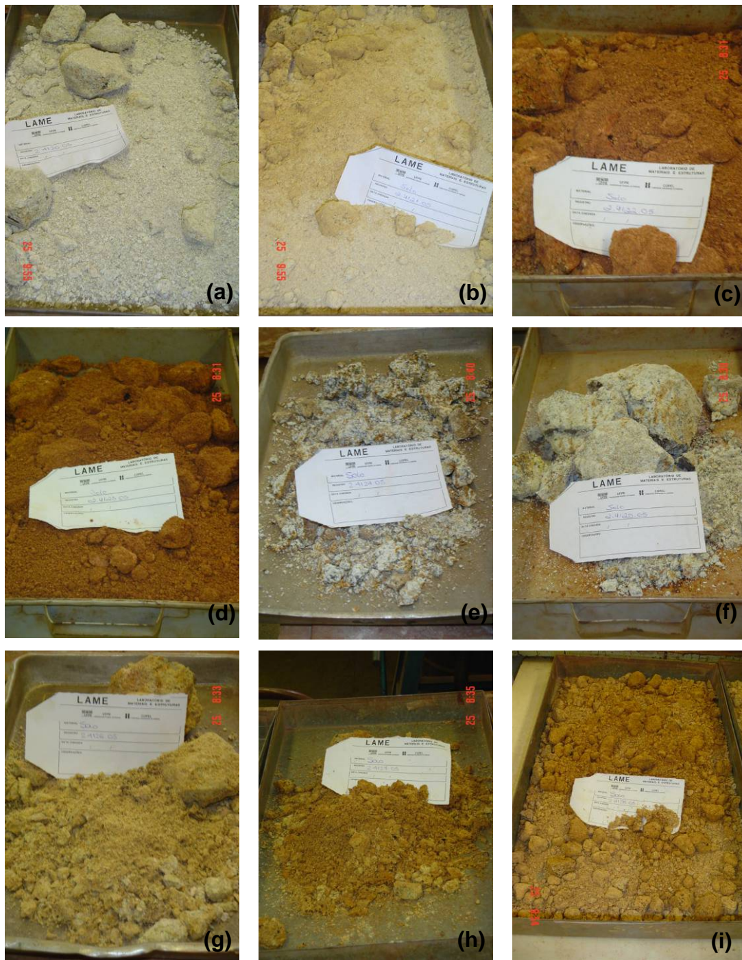
Figura 5.4 – Amostras deformadas coletadas no talude. (a) 2.4520.05 Branco. (b) 2.4521.05 Amarelo. (c) 2.4522.05 Vermelho. (d) 2.4523.05 Vermelho. (e) 2.4524.05 Branco. (f) 2.4525.05 Branco. (g) 2.4526.05 Amarelo. (h) 2.4527.05 Amarelo. (i) 2.4528.05 Laranja.
