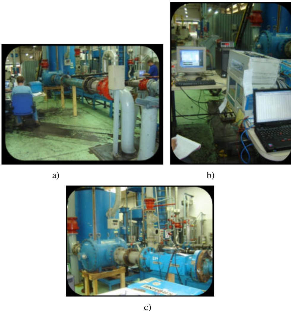
**Figura 26 – a) Medidor ASV inserido no circuito de calibração óleo mineral.**
