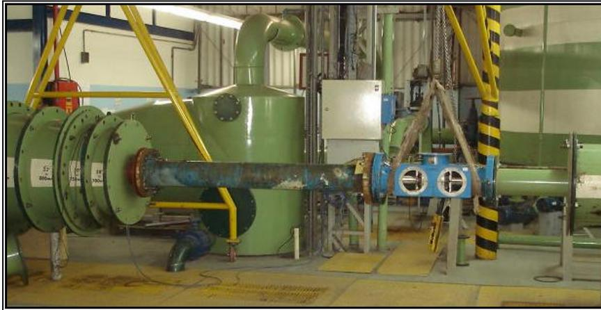
**Figura 16 – Medidor ASV inserido no circuito de calibração água.**
