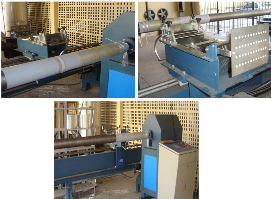
Figura 7 - Equipamento utilizado para a fabricação dos tubos.
