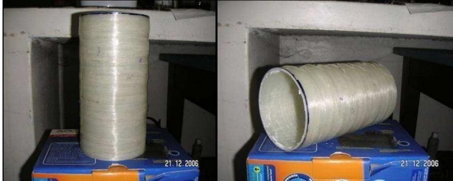
Figura 8 - Tubo fabricado no equipamento de Enrolamento Filamentar apresentado na Figura 7.
