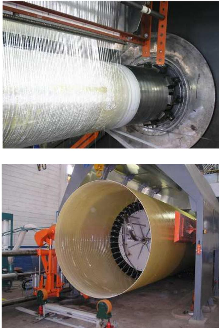
Figura 2 - Elementos sendo fabricados por Enrolamento Filamentar.
