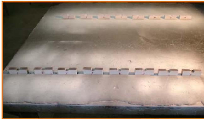
Figura 27: Corpos-de-prova com revelador.
