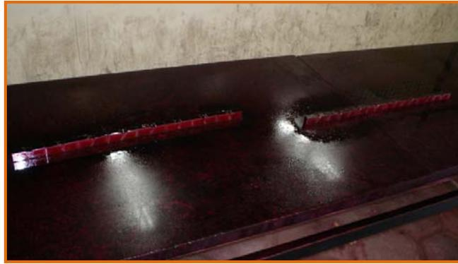
Figura 26: Corpos-de-prova com líquido penetrante vermelho.
