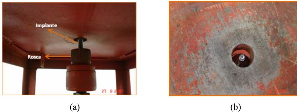
Figura 36: Implante aparafusado (a) vista inferior (b) vista superior.
