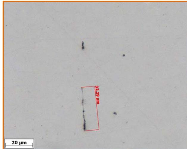
Figura 76: Amostra I1-1B: imagem: ZTA sem ataque.
