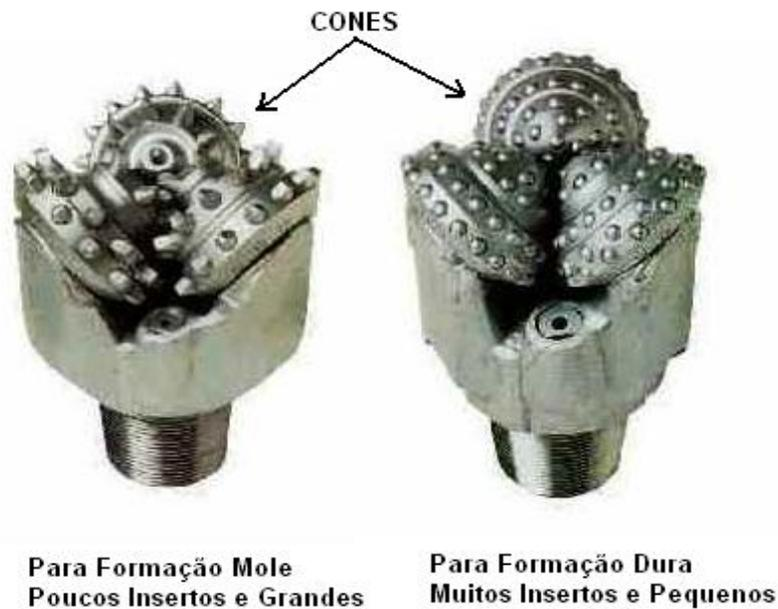
Figura 2.5: Broca de Perfuração Rotativa com partes móveis “Broca Tricônica” (Site [www.geocities.com.br](http://www.geocities.com.br)).
