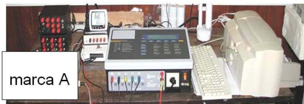
Figura 6.1: Conexões realizadas para análise de segurança elétrica da marca A.
