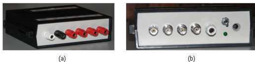
Figura 5.13: Condicionador de sinais para avaliação de exatidão de dados de operação (condicionador ECG). (a) Vista fronto-lateral; (b) Vista posterior.
