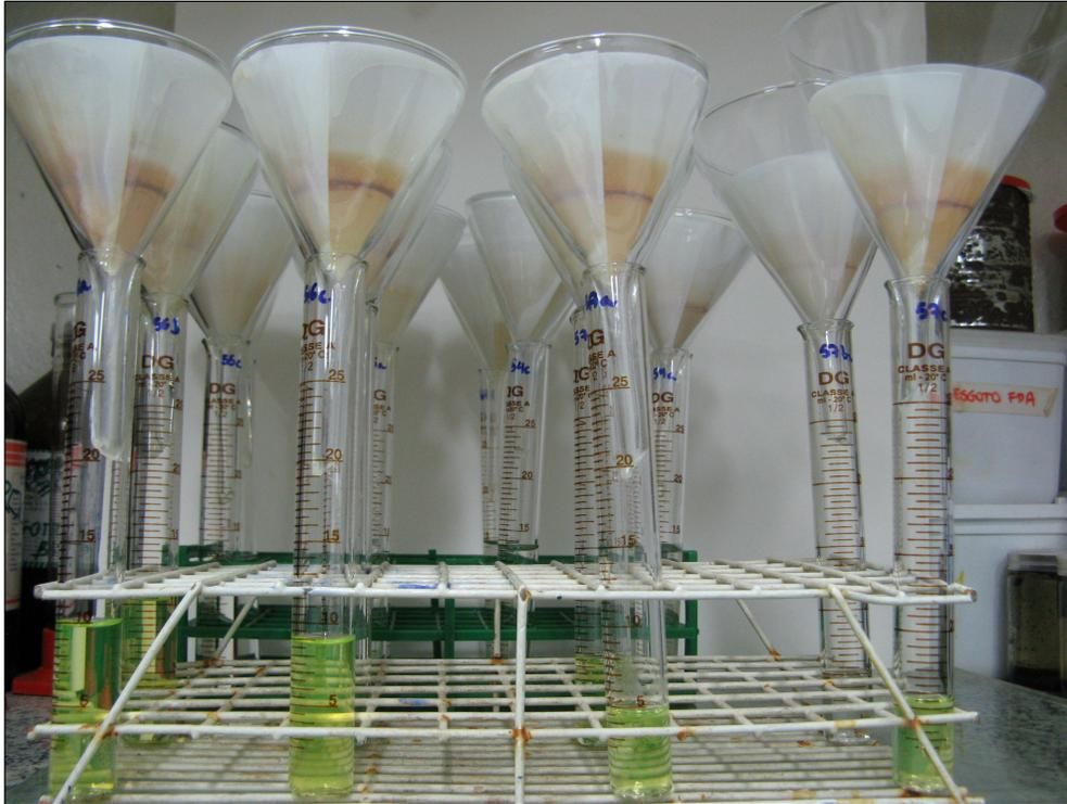
Figura 3.22 – Destaque para o volume de filtrado nas provetas e sua coloração esverdeada devido à presença de fluoresceína nas amostras.
