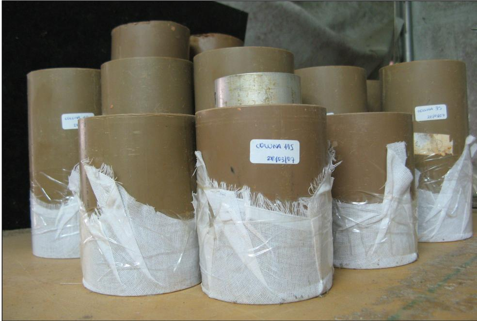
Figura 3.14 – Colunas de solo indeformado momentos antes da contaminação.
