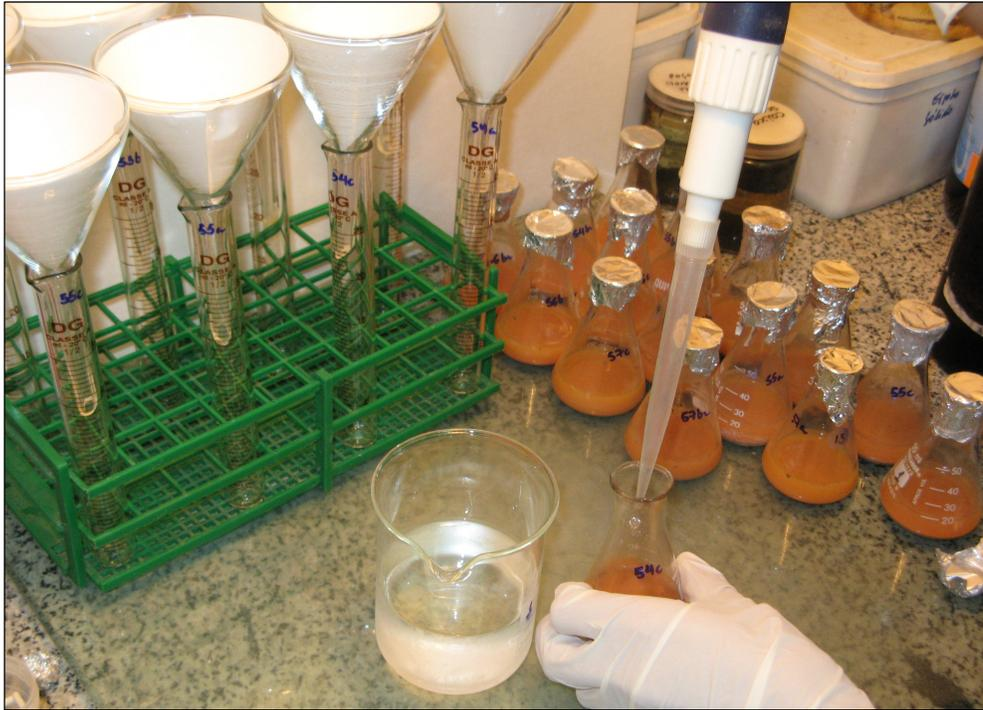
Figura 3.21 – Interrupção da reação através de solução clorofórmio / metanol.
