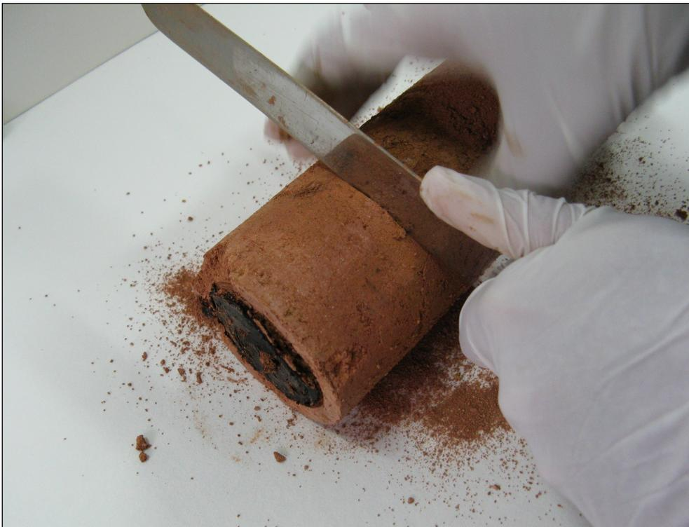
Figura 3.19 – Segmentação da coluna de solo indeformado.
