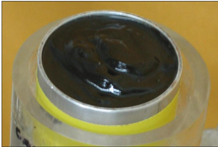
Figura 3.6 – Óleo utilizado nos ensaios de contaminação das esferas de vidro e do solo residual.
