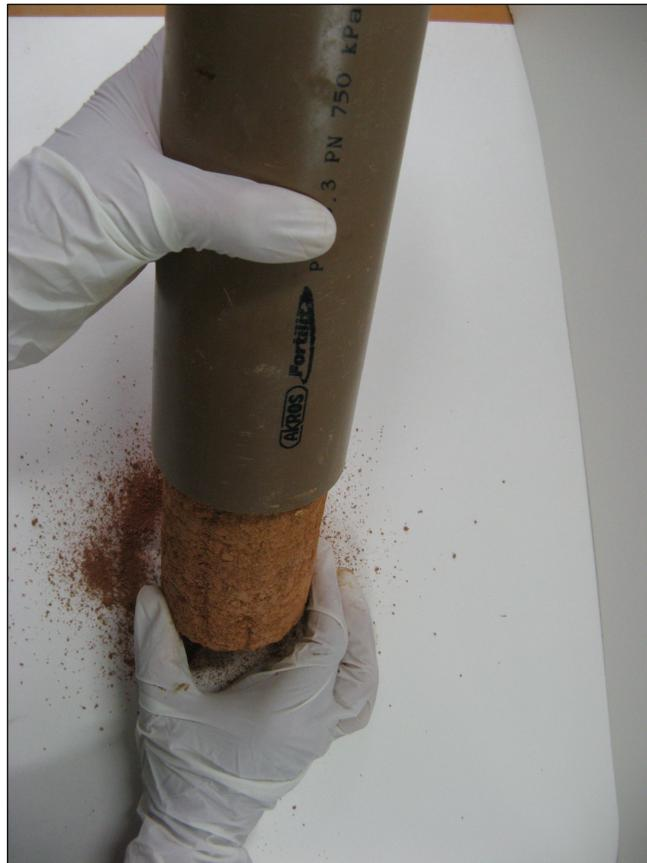
Figura 3.17 – Retirada do solo indeformado da coluna de PVC ao final do intervalo de tempo estipulado para o monitoramento da contaminação e da atividade microbiana.
