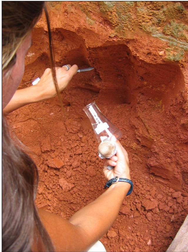
Figura 3.5 – Amostragem da feição areno-siltosa S1 para análise de hidrólise de diacetato de fluoresceína (FDA).
