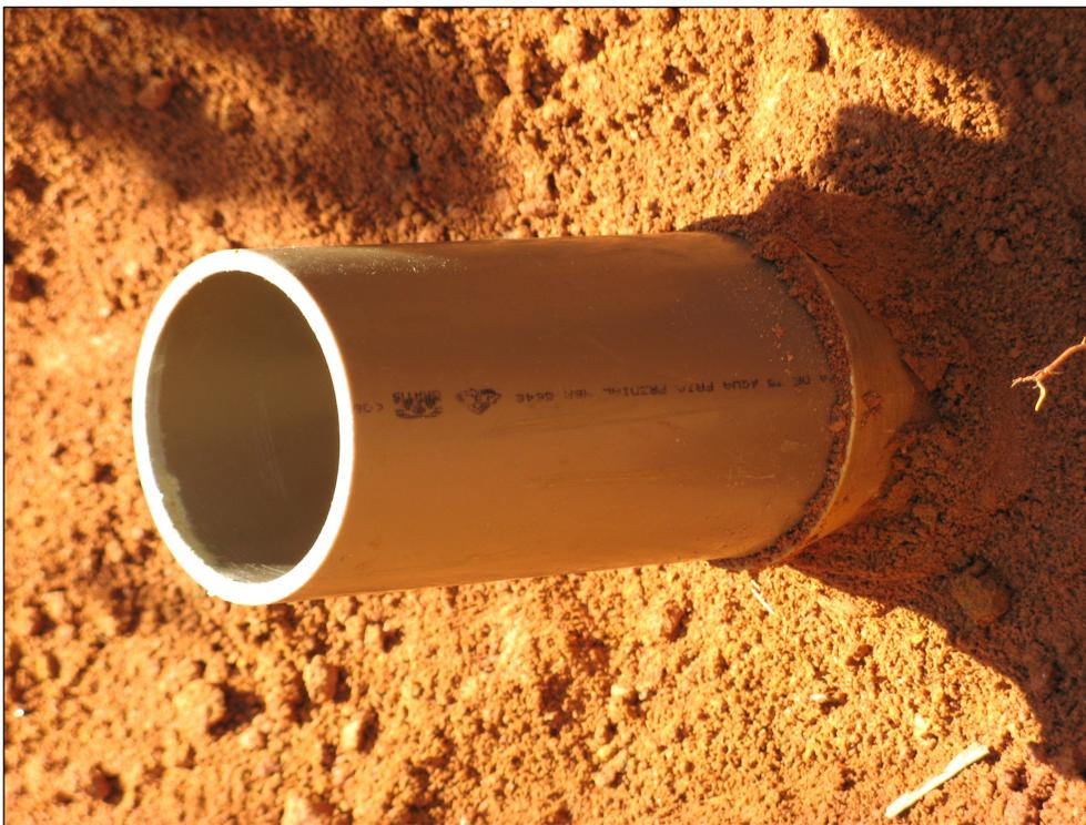
Figura 3.12 – Início da etapa de amostragem das colunas de solo residual indeformado.
