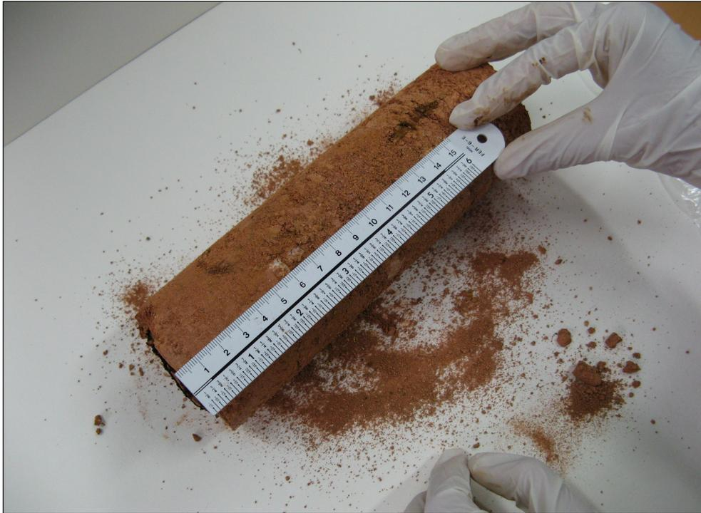
Figura 3.18 – Solo indeformado contaminado momentos antes de sua segmentação.
