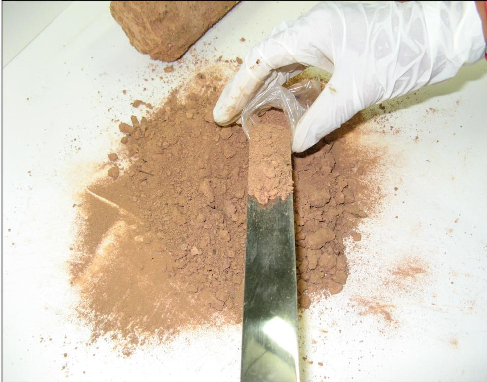
Figura 3.20 – Retirada de amostras compostas de solo amolgado para posteriores análises químicas e microbiológicas.
