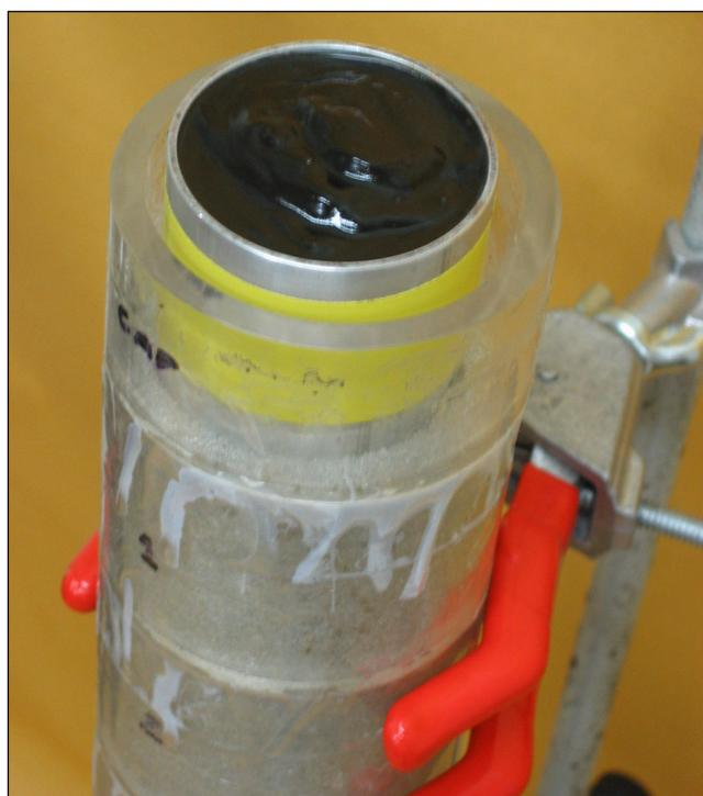
Figura 3.11 – Detalhe do óleo mineral no topo da coluna no início da contaminação.
