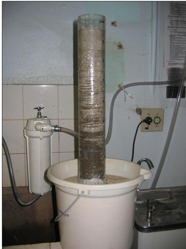
Figura 3.8 – Metodologia de drenagem através da utilização de areia grossa como material drenante.
