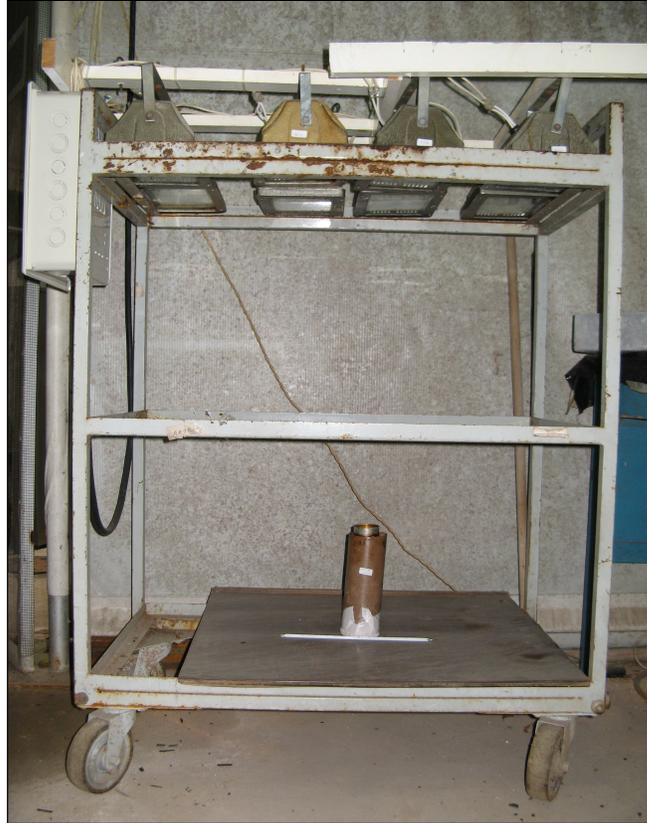
Figura 3.15 – Estrutura suporte aos refletores de 300W e de 500W. No topo da figura à esquerda destaque à vista lateral da caixa de disjuntores por meio da qual se fez o controle dos refletores.
