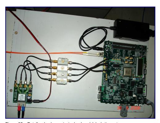
Figura 35 – Detalhe da placa principal e do módulo óptico externo
