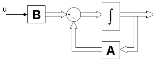
Figura 64: Sistema de Controle de Malha Aberta.
