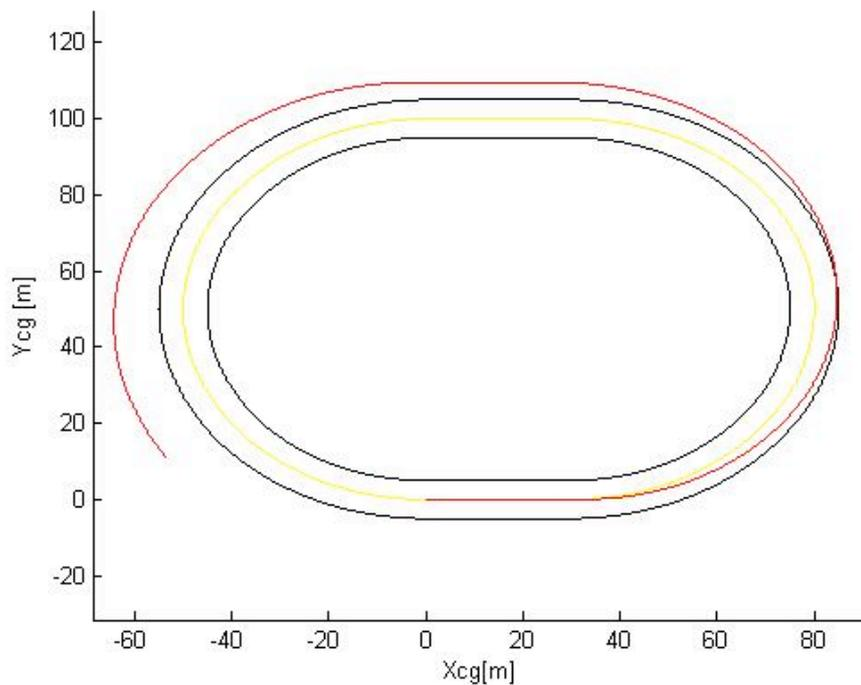
Figura 75: Deslocamento do C.G. - Pista Fechada - Pólos em -8,-9,-10,-11.
