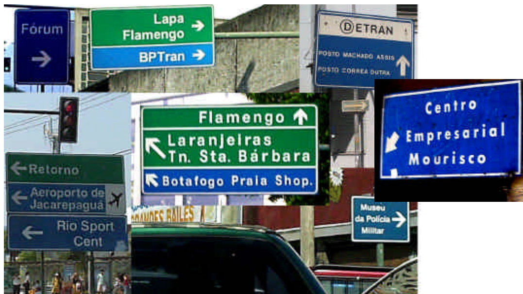
Figura 1.21 - Montagem com sinalizações verticais de indicação, elegendo pontos de interesse na cidade.
