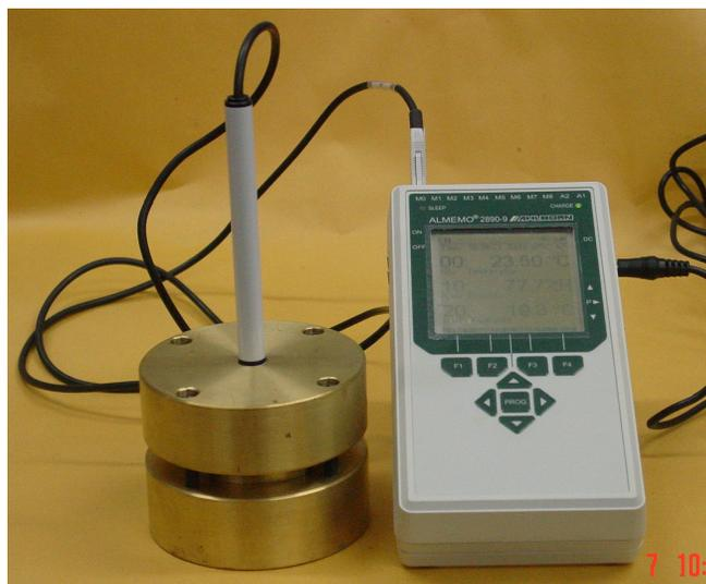
Figura 6.1 – Determinação da Umidade Relativa – Montagem do ensaio (Sonda e Datalogger Ahlborn)
