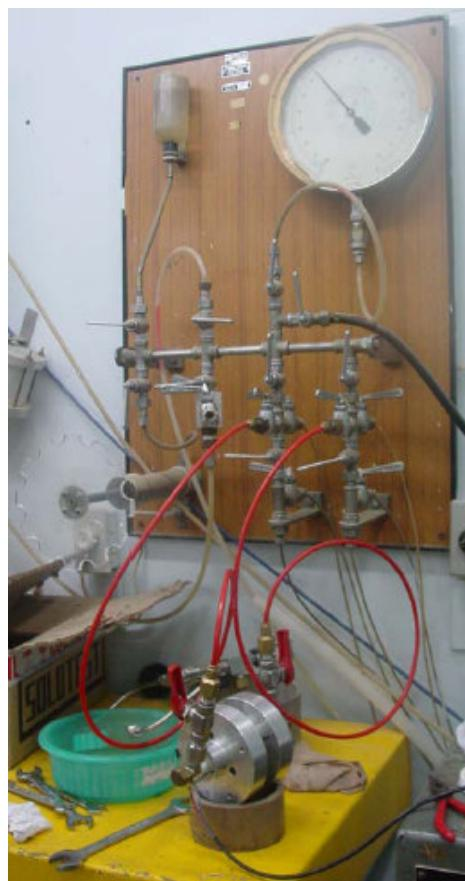
Figura A2-8 – Sistema de calibração com bomba e manômetro (até 500kPa)
