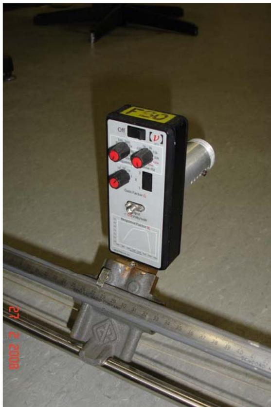
Figura 41 – Dispositivo de avaliação do perfil de intensidade do feixe.
