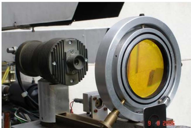
Figura 54 - Receptor de 9,1  $\mu\text{m}$ .
