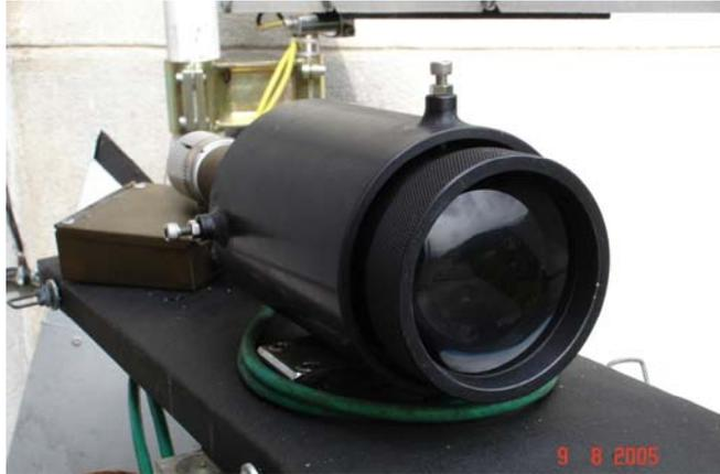
Figura 53 – Receptor de 1550 nm, idêntico ao de 780 nm.
