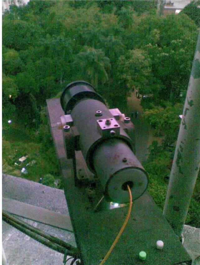
Figura 48 – Canhão de 1550 nm sem a cobertura de proteção.
