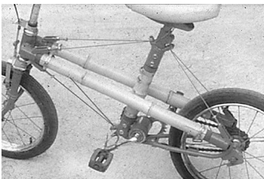
Bicicleta com estrutura tensegrity de bambu e cabos de aço. (LILD).
