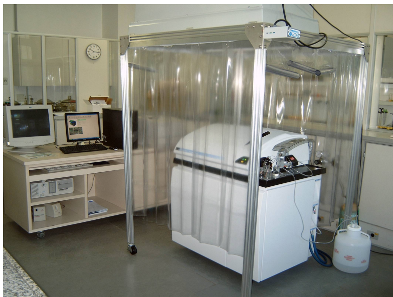
Figura 5– Fotografia do ELAN DRC-II, hospedado em câmara de fluxo laminar, do laboratório de ICPMS da PUC-RIO e adquirido em julho de 2007.
