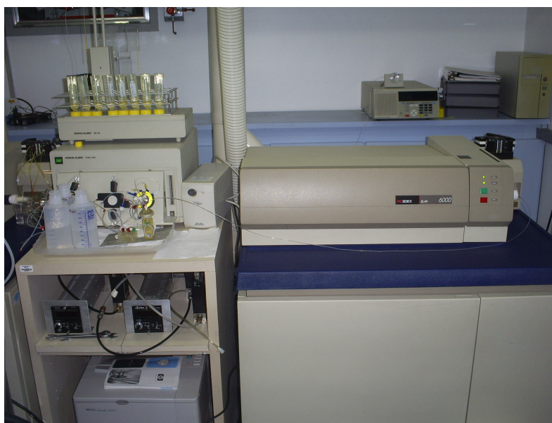
Figura 3 – Fotografia mostrando o sistema de HG-ICPMS utilizada neste trabalho.
