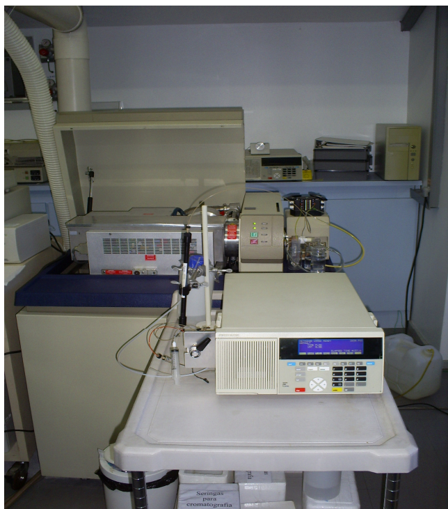
Figura 4 – Fotografia mostrando o sistema cromatográfico acoplado ao ICP-MS do Depto. de Química da PUC-Rio.
