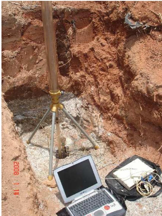
Figura 3.6 - Vista do ensaio de infiltração monitorada (E.I.M.).
