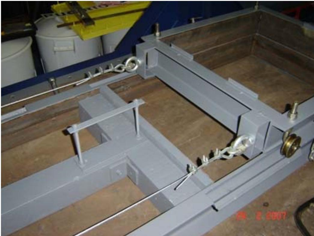
Figura 165 - Instalação dos cabos de aço nos anéis de carga da caixa superior.
