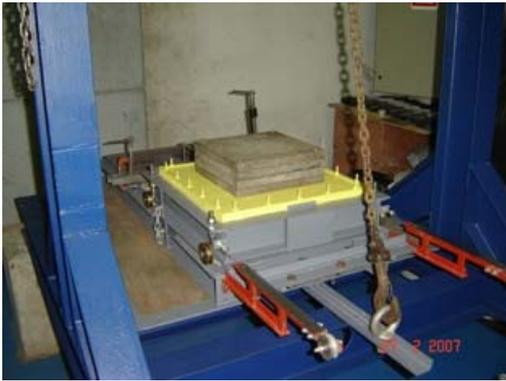
Figura 160 - Colocação das placas de confinamento.
