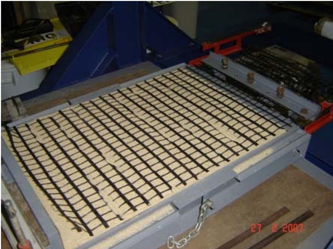
Figura 158 - Geogrelha na posição de ensaio.
