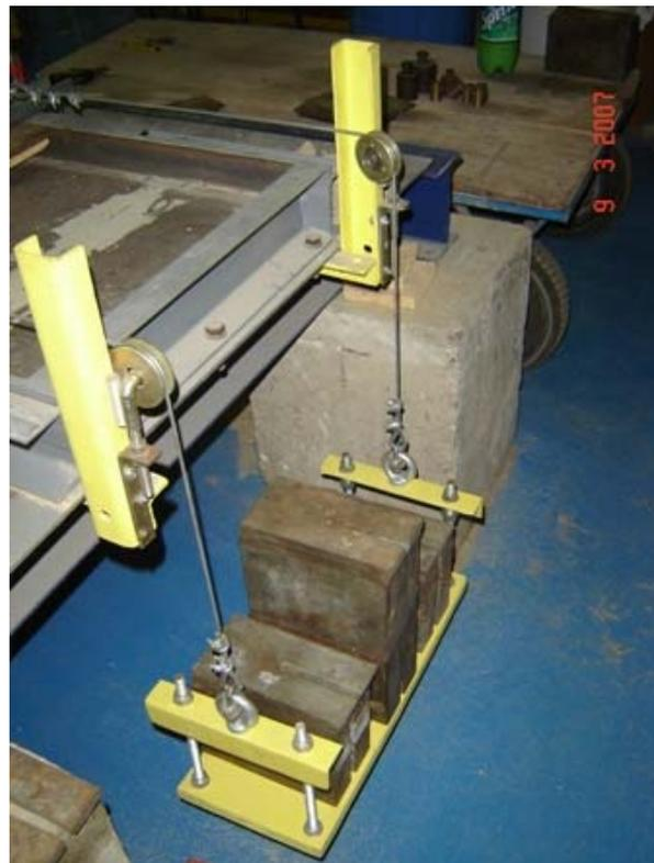
Figura 171 - Aplicação de tensão cisalhante.
