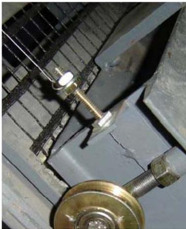
Figura 108 - Fixação do *tell-tale* na caixa superior.
