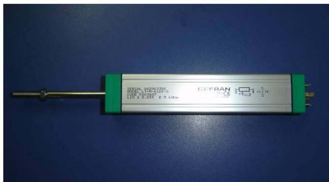
Figura 110 - Medidor de deslocamento horizontal marca Gefran.
