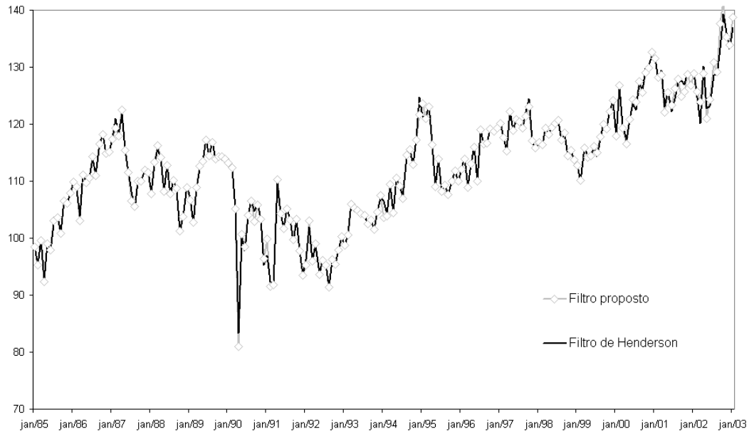
Gráfico 4.32 – Séries ajustadas sazonalmente utilizando o Filtro Proposto e o Filtro de Henderson
