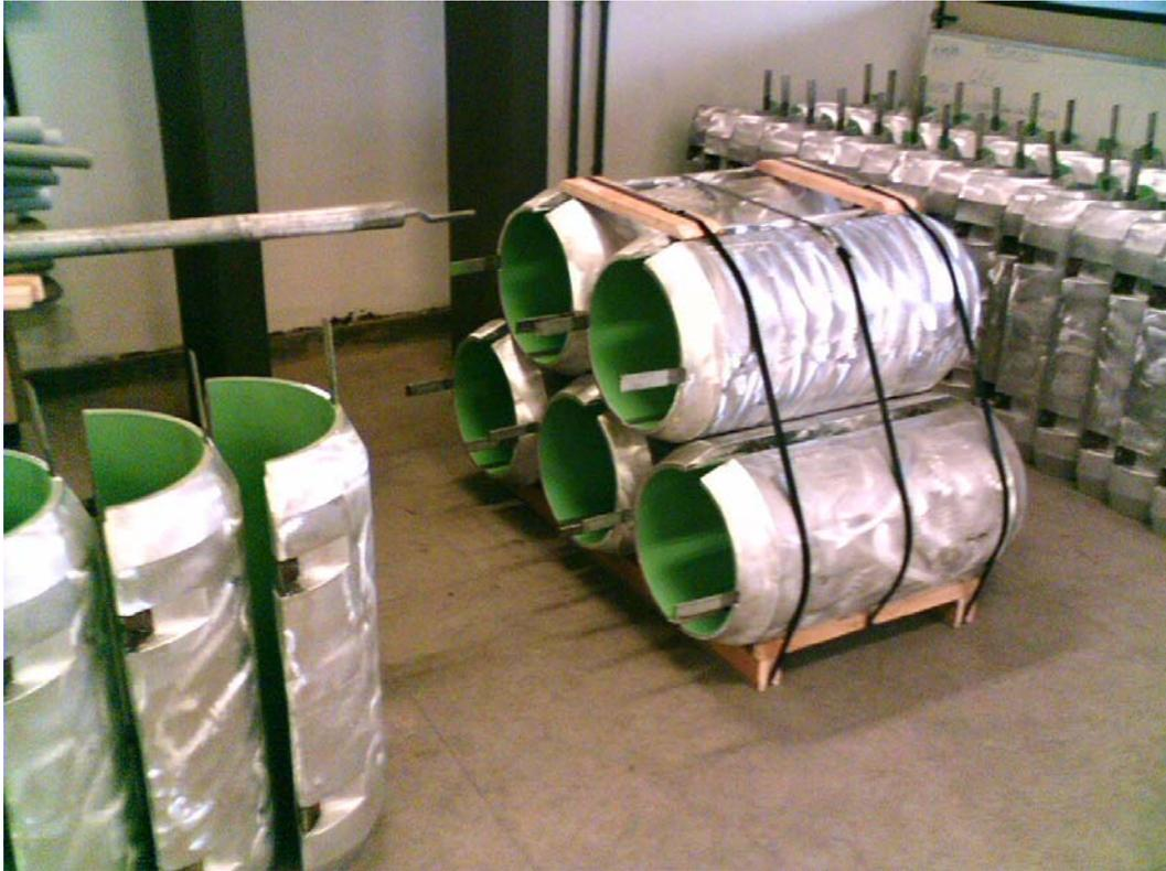
Figura 26 – Fotos de anodos de dutos rígidos da empresa SACOR
