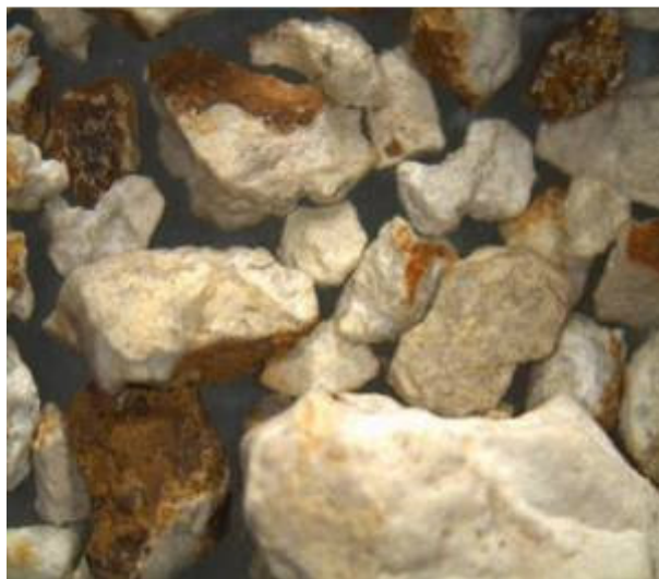
Figura 5-15 – Amostra 04 – Pedregulho e areias grossa, média e fina.
