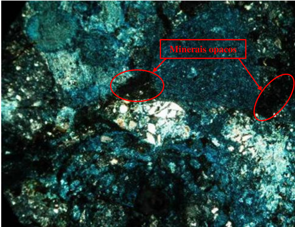
Figura 5-34 – Fotomicrografia da amostra 04 – Presença de minerais opacos. Aumento de 10 vezes. Luz plana.
