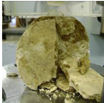
Figura 5-57 – Ruptura parcial do corpo de prova – apresentação da heterogeneidade. Amostra 04.
