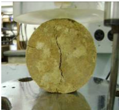
Figura 5-52 – Aumento da formação da trinca com o avanço das deformações. Amostra 02.
