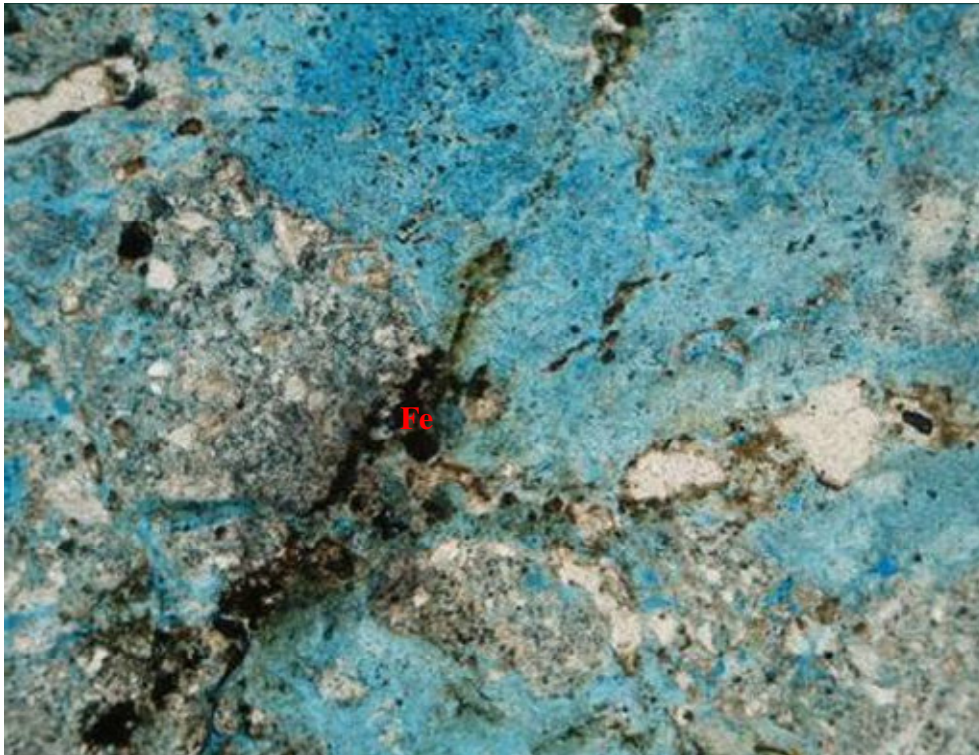
Figura 5-29 – Fotomicrografia da amostra 03 – Plasma com hidróxido de ferro e alta quantidade de poros. Aumento de 5 vezes. Nicóis cruzados. Fe – Hidróxido de ferro.
