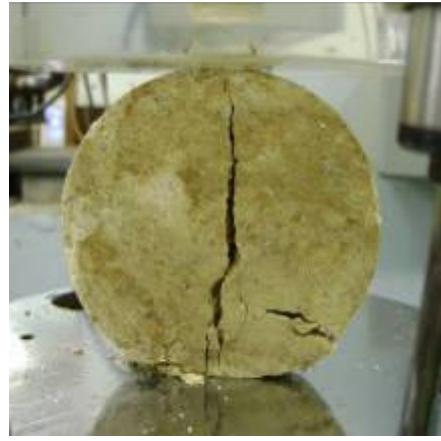
Figura 5-55 – Abertura da trinca com a aplicação da força. Amostra 04.
