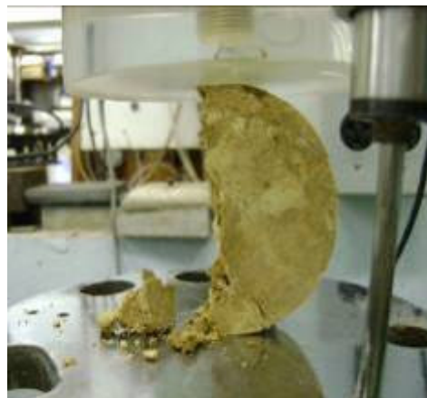
Figura 5-53 – Ruptura total da amostra de solo. Amostra 02.
