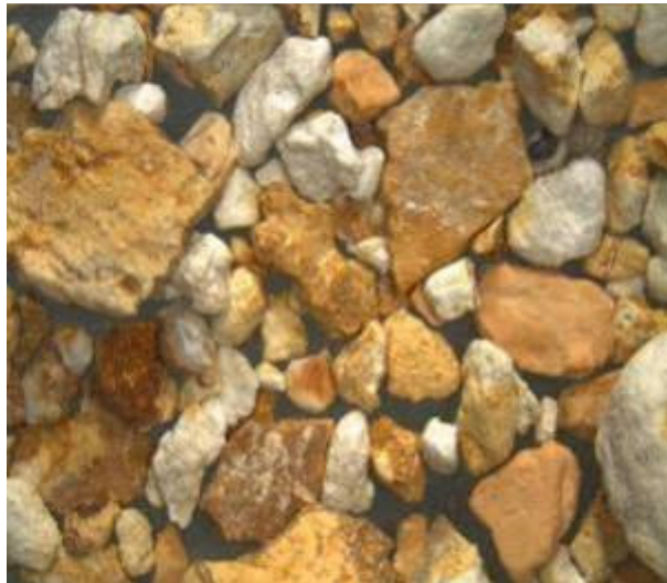
Figura 5-14 – Amostra 03 – Pedregulho e areias grossa, média e fina.
