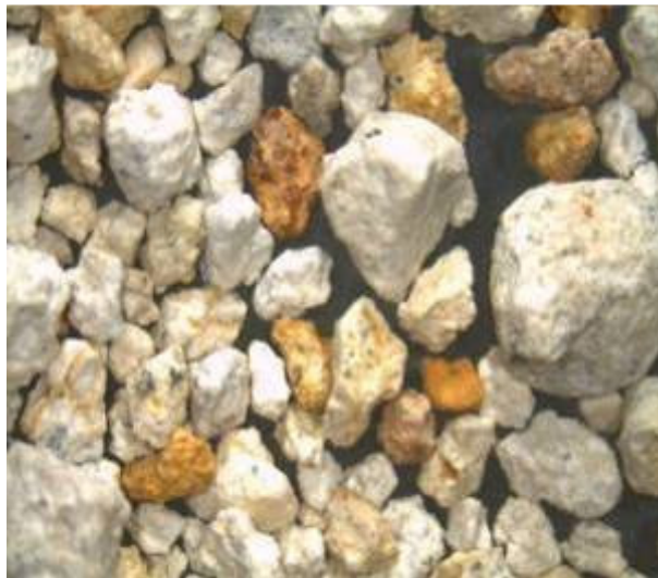
Figura 5-13 – Amostra 02 – Pedregulho e areias grossa, média e fina.
