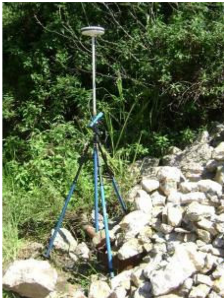
Figura 3-4 – Estação base do GPS, shaft 01.
