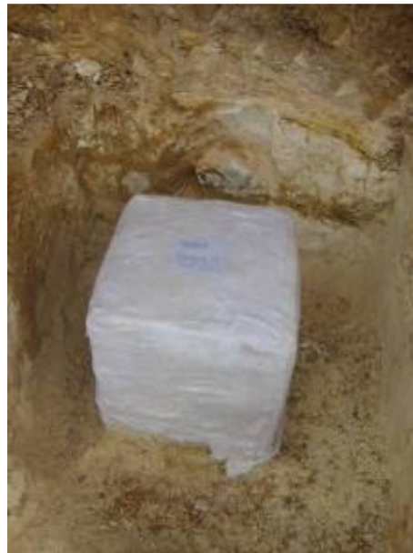
Figura 3-11 – Preparação dos blocos em campo, amostra 02.
