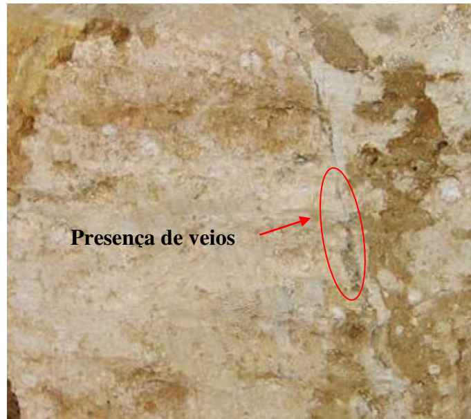
Figura 3-14 – Amostra 02 evidenciando a presença de veios.
