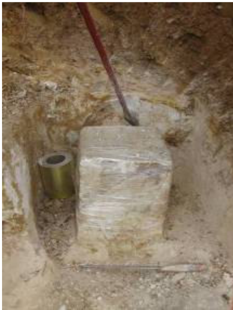
Figura 3-10 – Preparação dos blocos em campo, amostra 02.
