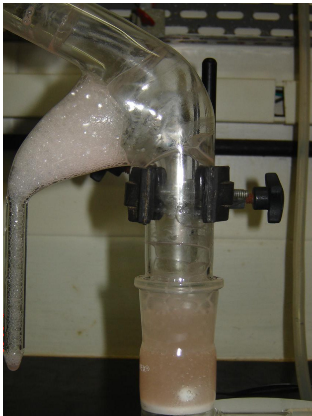
Figura 79. Formação de espuma na flotação do Níquel mediante R. opacus , no tubo de Hallimond.
