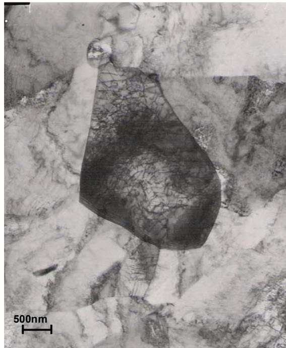
Figura 26. Imagem em MET de uma fase escura localizada entre grãos de ferrita poligonal, na amostra de aço Nb-Cr-Mo pós-laminado. A fase escura é um constituinte AM.
