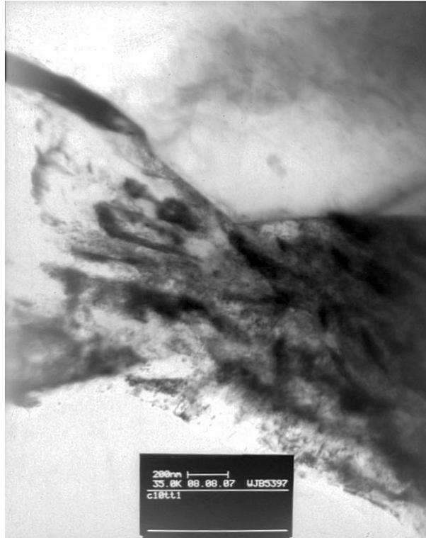
Figura 51. Fase escura com uma subestrutura interna visível no aço Nb-Cr-Mo-V resfriado ao ar. A fase parece ser um AM em fase de decomposição.
