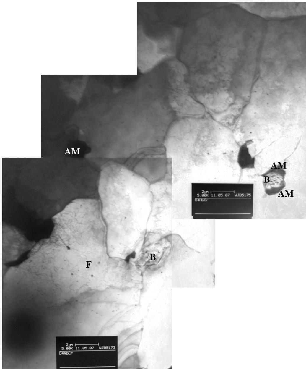
Figura 41. Observação no MET da microestrutura do aço Nb-Cr-Mo resfriado ao ar ( $1,5^{\circ}\text{C/s}$ ) : AM - constituinte austenita retida-martensita, B - bainita, F – ferrita
