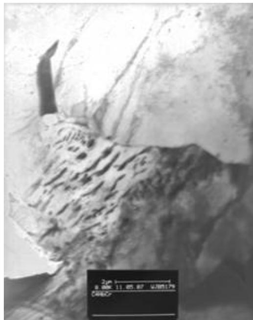
Figura 43. (a) Grão de bainita no aço Nb-Cr-Mo resfriado ao ar ( $1,5^{\circ}\text{C/s}$ ). O grão de ferrita adjacente possui várias discordâncias e a ponta do grão de bainita apresenta uma partícula de AM alongado.
