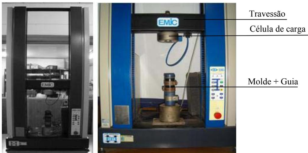
Figura 24. Máquina universal de ensaios utilizada para a compactação.
