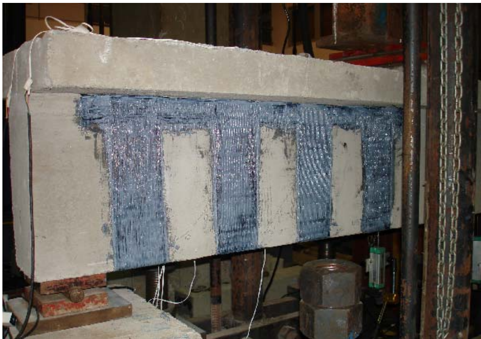
Foto A.13 – Viga reforçada à força cortante com CFC.
