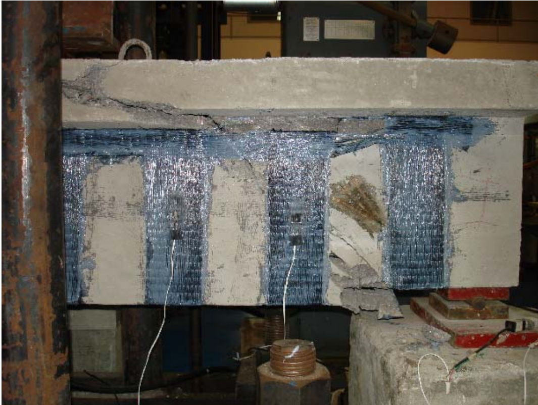
Foto A.27 – Detalhe da ruptura da viga VI-3 (1).
