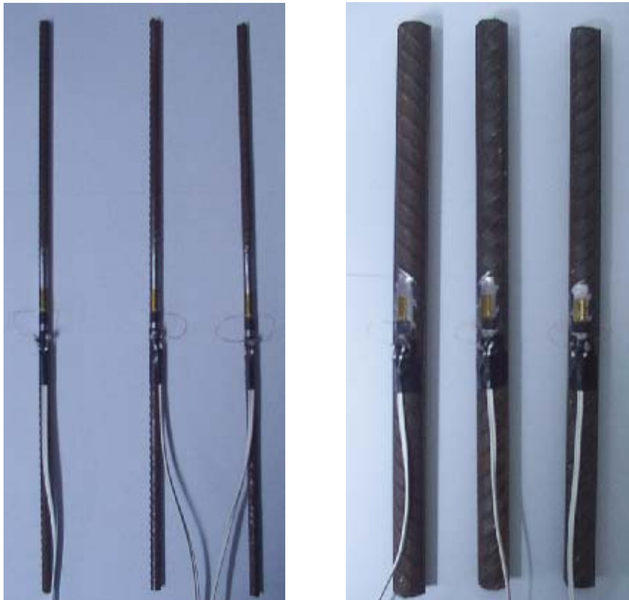
Foto A.4 – Amostras das barras de aço de 5,0 e 16,0 mm para os ensaios de resistência tração.
