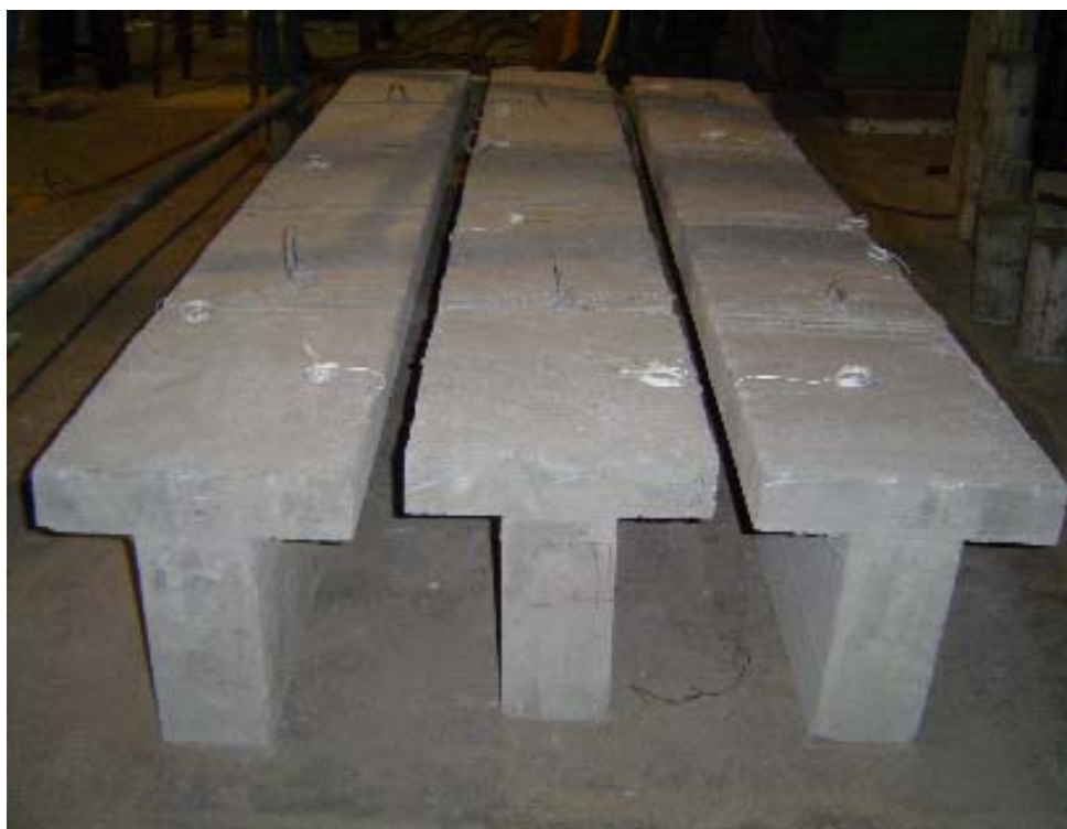
Foto A.10 – Vigas após as desformas.
