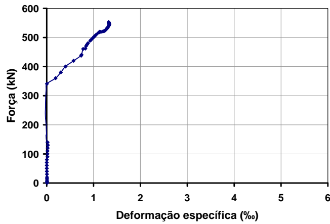
Figura E.9 – Diagrama força x deformação específica do aço referente ao extensômetro SG3 colado num estribo da viga VI-1.
