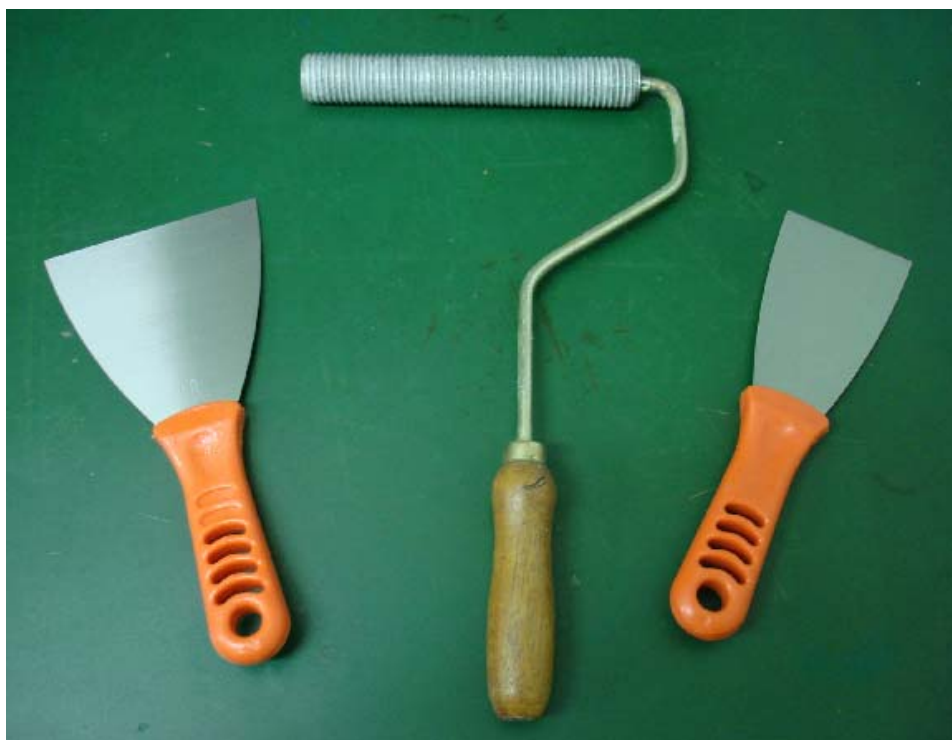
Foto A.12 – Equipamentos diversos (espátulas e rolo "tira-bolha") utilizados na aplicação da resina epoxídica.
