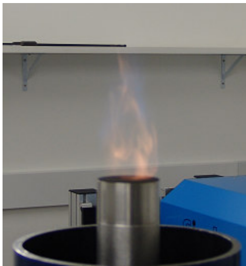
Figura 5.2.4.7 Fotografia direta da chama para o caso 7 com tempo de exposição de 1/500 segundos.
