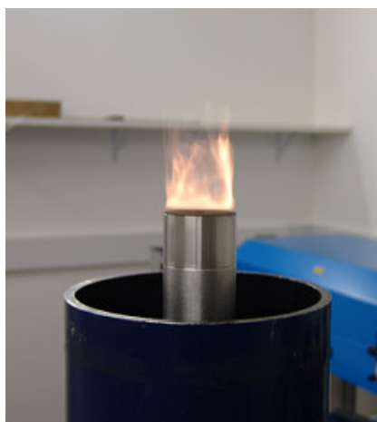
Figura 5.2.4.4 Fotografia direta da chama para o caso 6 com tempo de exposição de 1/500 segundos.
