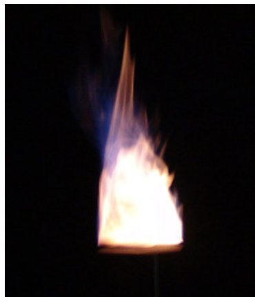
Figura 5.2.5.1 Fotografia direta da chama para o caso 8 com tempo de exposição de 1/1000 segundos.
