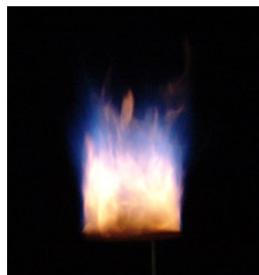
Figura 5.2.4.13 Fotografia direta da chama para o caso 10 com tempo de exposição de 1/1000 segundos.
