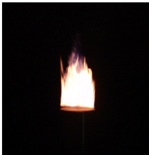
Figura 5.2.4.1 Fotografia direta da chama para o caso 5 com tempo de exposição de 1/1000 segundos.
