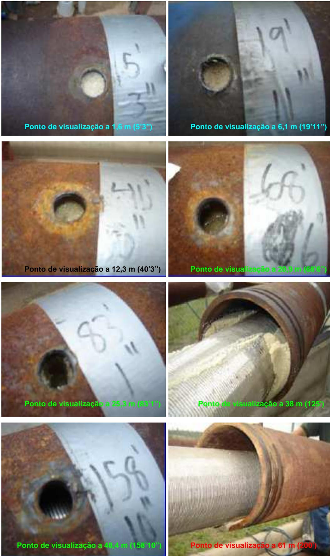
Figura 7.6 - Imagens da qualidade do empacotamento capturadas ao fim do teste 2A
