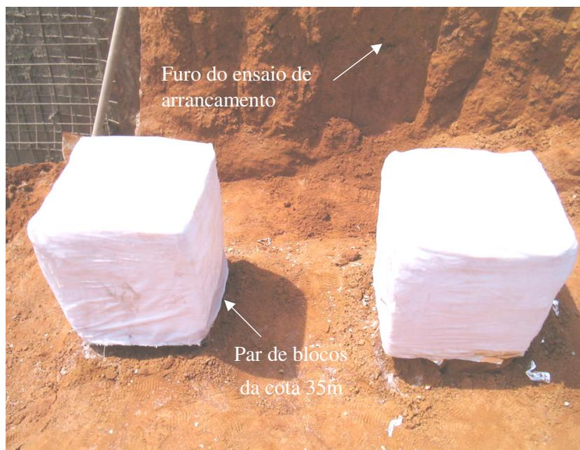
Figura 47 – Amostras indeformadas após moldagem e embalagem com parafina.
