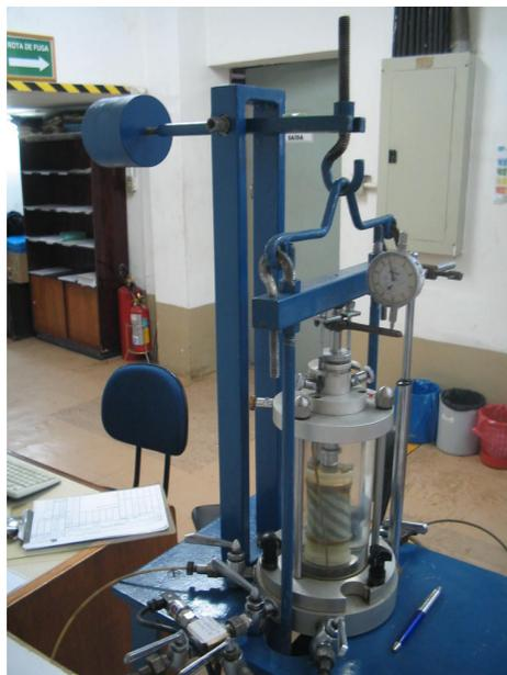
Figura 76 - Prensa Utilizada para o Ensaio de Descarregamento Lateral.
