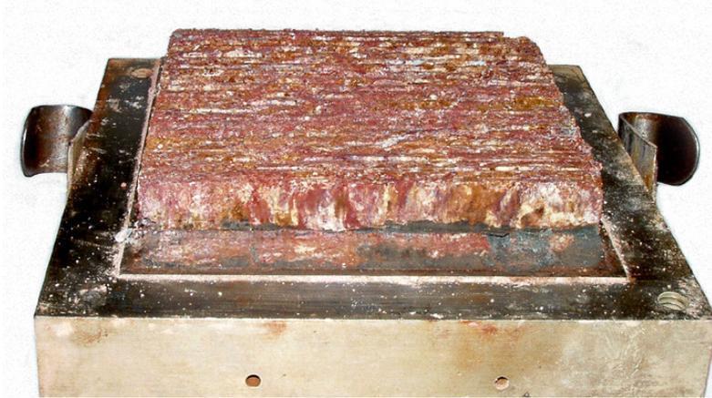
Figura 63 - Corpo-de-prova de interface solo/nata de cimento após o ensaio (Proto Silva, 2005)
