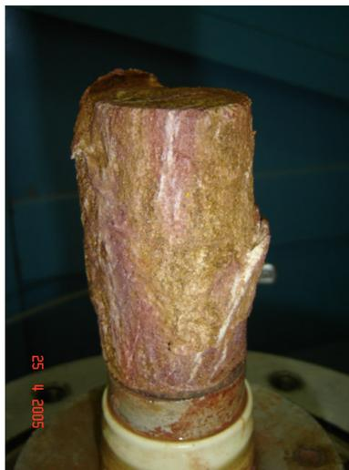
Figura 70 - Corpo de Prova após a Ruptura
