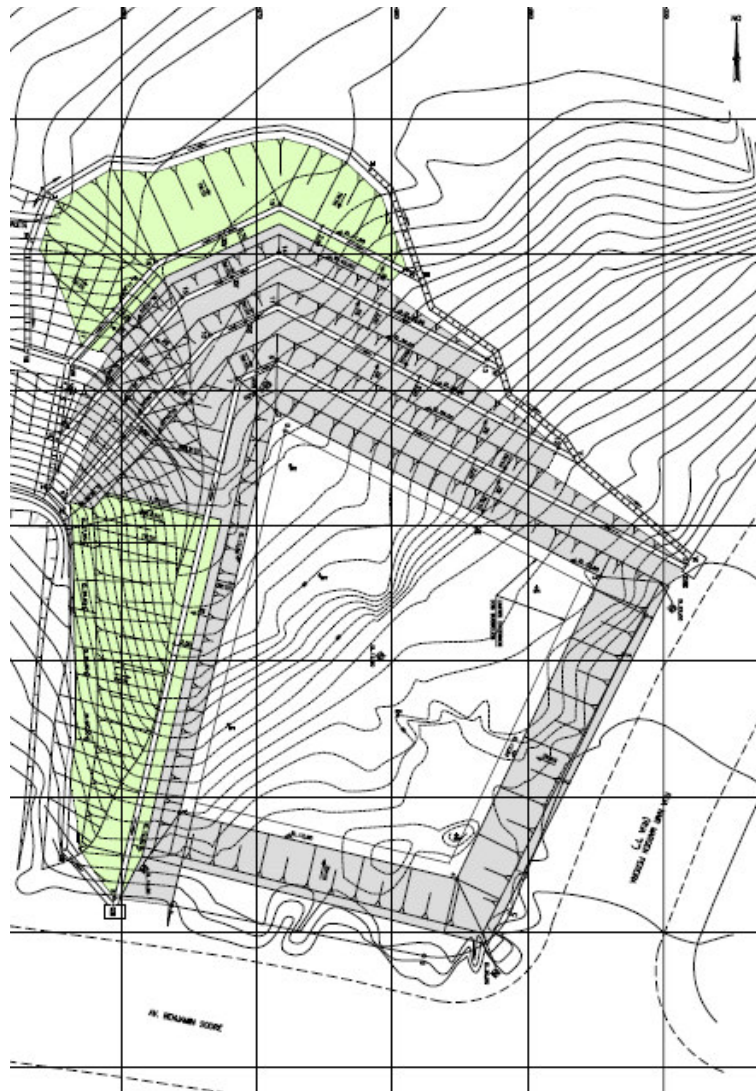
Figura 42 - Vista em Planta da Área Escavada (Geoprojetos, 2004).
