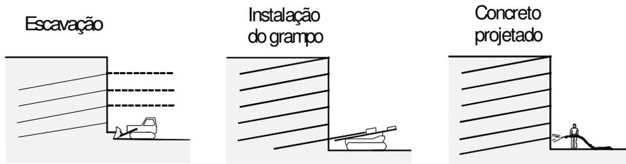
Figura 3 - Diversas fases construtivas de um solo grampeado
