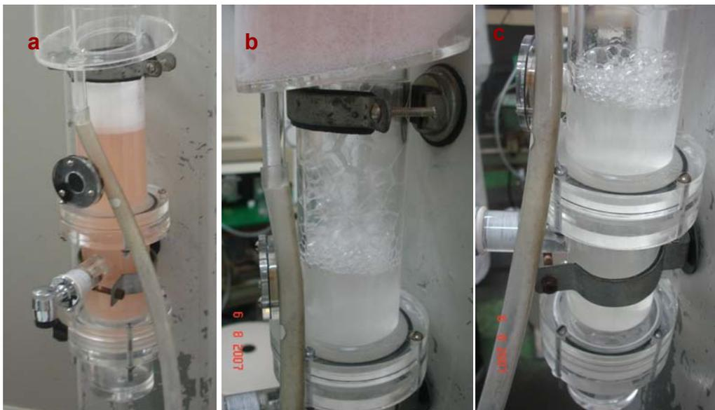
Figura 37 - Formação da espuma no processo de bioflotação de Pb(II) mediante *R.opacus*, numa coluna de flotação por ar disperso a pH 5,0, temperatura  $25 \pm 2^\circ\text{C}$ . a) Coluna de Bioflotação de diâmetro interno 5,7 cm e comprimento 75 cm. b) Formação de espuma depois dos primeiros 10 minutos de bioflotação. c) Formação de espuma no final do processo.
