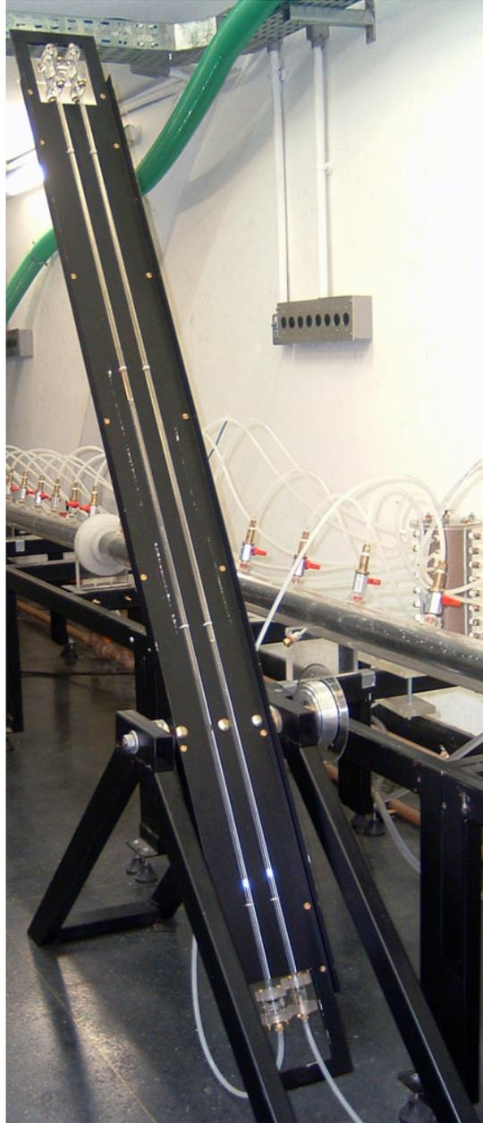
Figura 2.20: Manometro do tipo "U" invertido construído.
