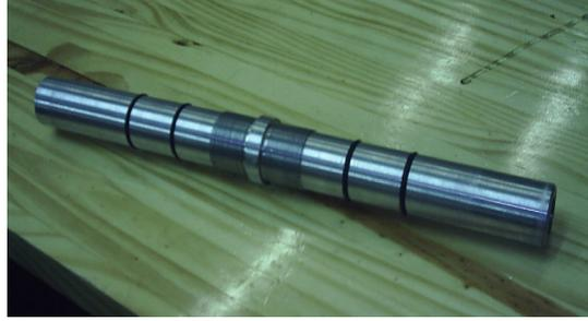
Figura 2.2: Foto da luva de união dos tubos de alumínio.
