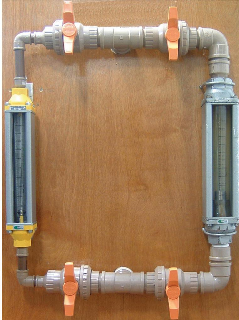
Figura 2.13: Fotos dos rotômetros utilizados para a leitura da vazão.
