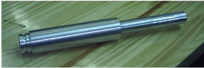
Figura 2.3: Foto da tampa do eixo de alumínio.
