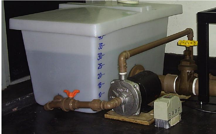
Figura 2.14: Foto do tanque inferior, bomba centrífuga, inversor de frequência e válvula gaveta.
