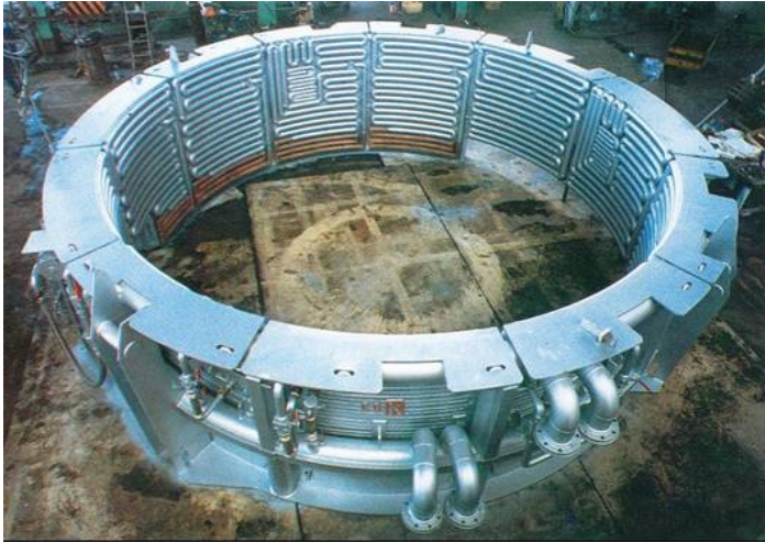
Figura 56 – Vista interna da carcaça de um forno elétrico, evidenciando os painéis refrigerados a água.
