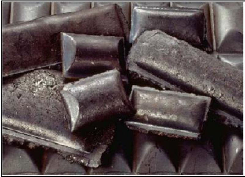
Figura 37 – Diferentes formas e volumes para os briquetes de HBI (75) . O volume típico dos briquetes produzidos equivale a aproximadamente 100 cm 3 .
