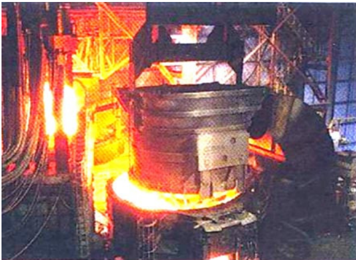
Figura 72 – Carregamento de carga sólida por cesto em um forno elétrico (98) .
