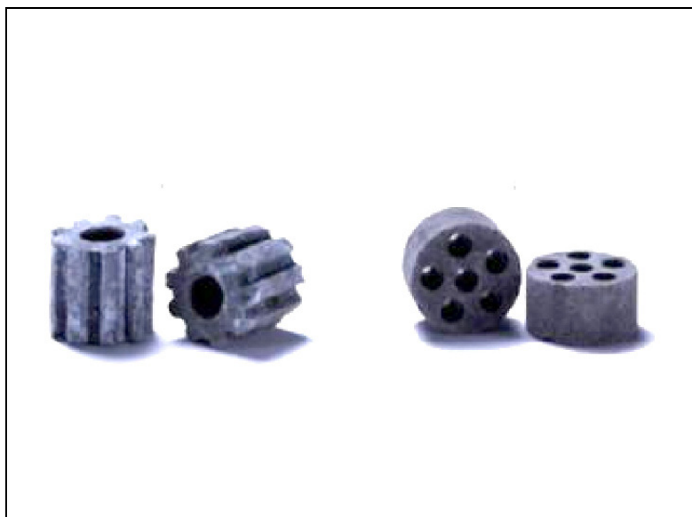
Figura 30 – Foto de catalisadores utilizados nos reformadores empregados pela tecnologia Midrex de produção de ferro-esponja (64) .
