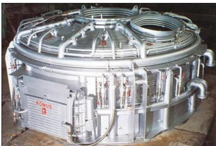
Figura 55 – Vista externa da carcaça superior de um forno elétrico.
