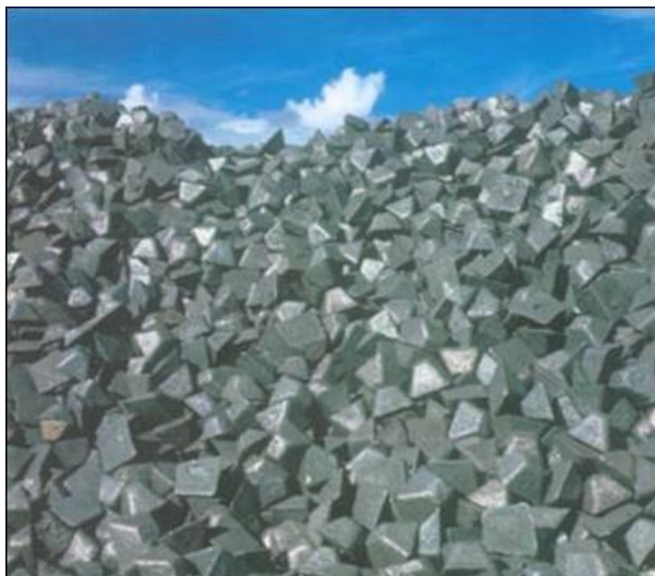
Figura 63 – Pilha de lingotes de ferro-gusa sólido, produzidos a partir de mini altos-fornos.
