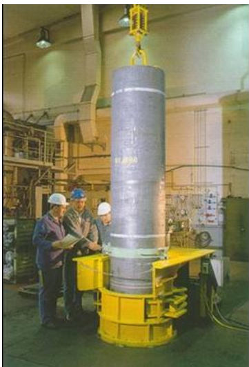
Figura 66 – Eletrodo de grafite para emprego em fornos elétricos a arco.
