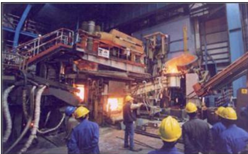
Figura 73 – Carregamento de gusa líquido em um forno elétrico a arco (98) .
