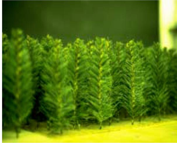
Figura 4.3: Modelos de árvores de Natal utilizadas nos experimentos de túnel de vento. Fonte: Novak et al. (2001).
