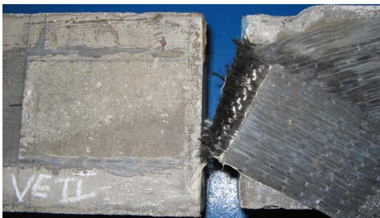
Figura 4.2 – Ruptura por descolamento do adesivo no corpo-de-prova VE II 04.
