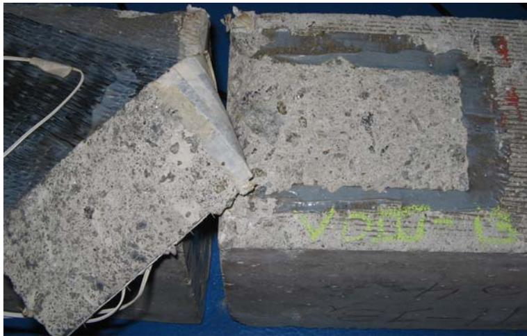
Figura 4.1 – Ruptura por destacamento do concreto no corpo-de-prova VD III 12.
