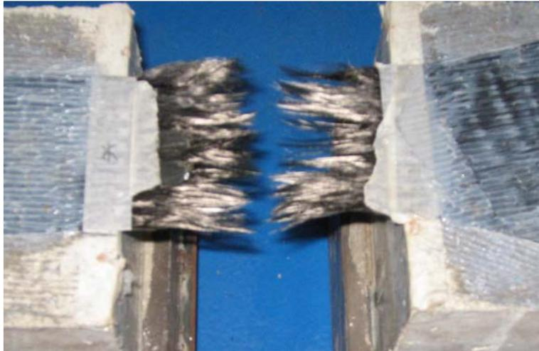
Figura 4.3 – Ruptura das fibras de carbono no corpo-de-prova VE III 13.
