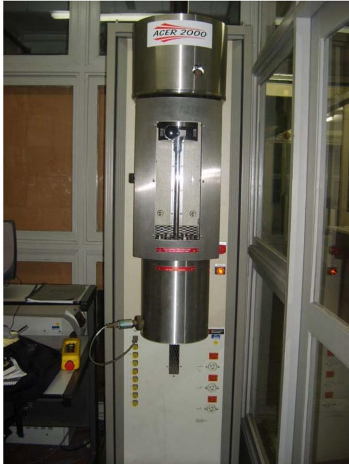
Figura 2.2: Reômetro capilar ACER 2000.
