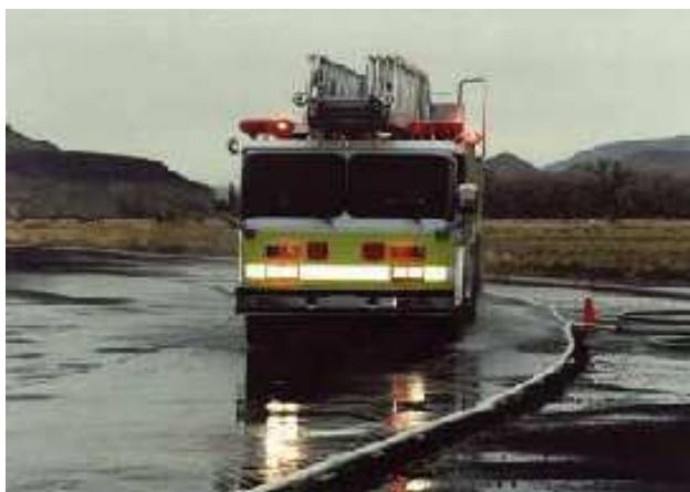
Figura 8.04 – Teste em pista – Aceleração, frenagem e execução de curvas em raios tangenciais (30°, 60°, 90, 120°), ou em raio estático (raio mínimo), em pista de teste com várias condições de atrito (asfalto, concreto poroso e concreto liso nas condições de seco e molhado) –[25].
