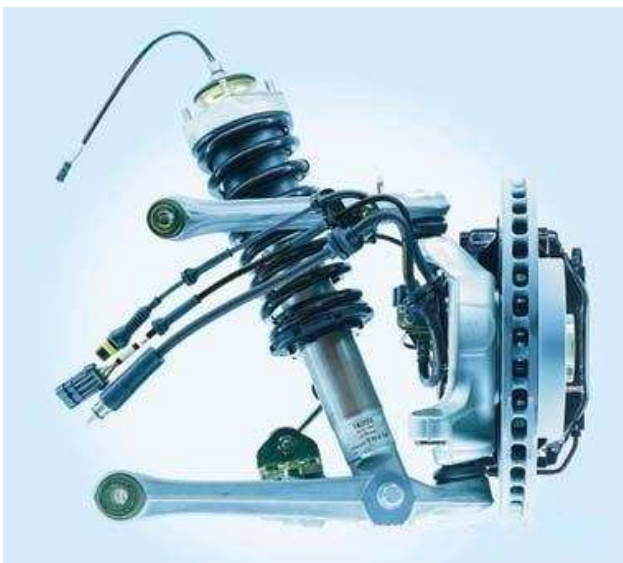
Figura 2.16 – Sistema de Bandeja Dupla usado no Maserati Spyder.
